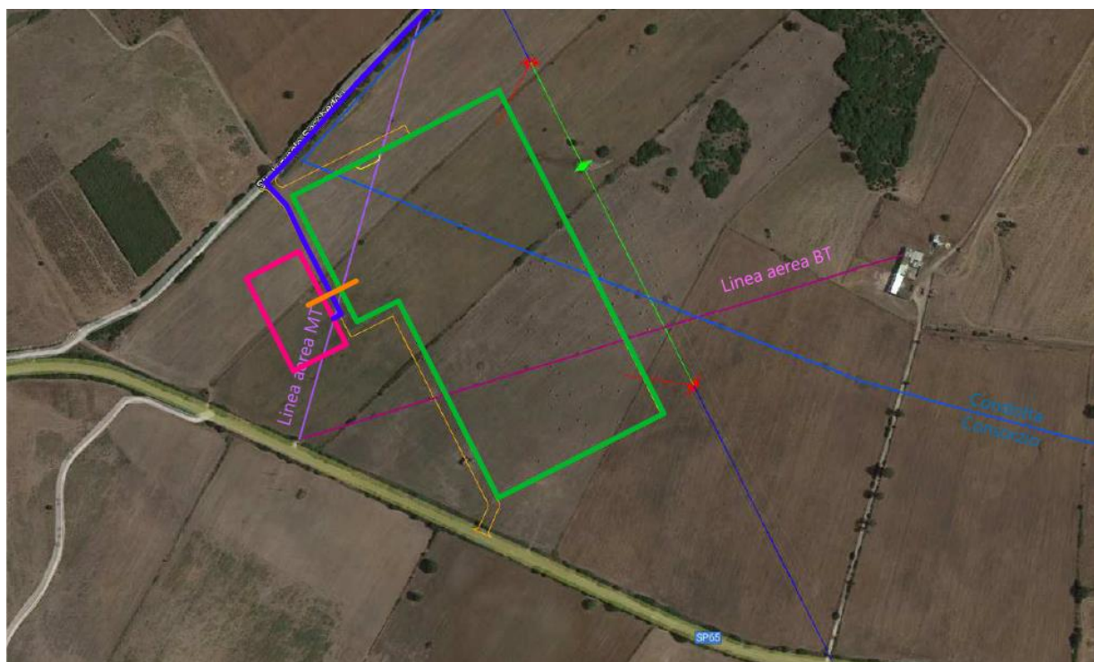
Figura 4: Infrastrutture esistenti nell'area identificata per la nuova Stazione SEU per la SE RTN OLMEDO e per i raccordi linea.
