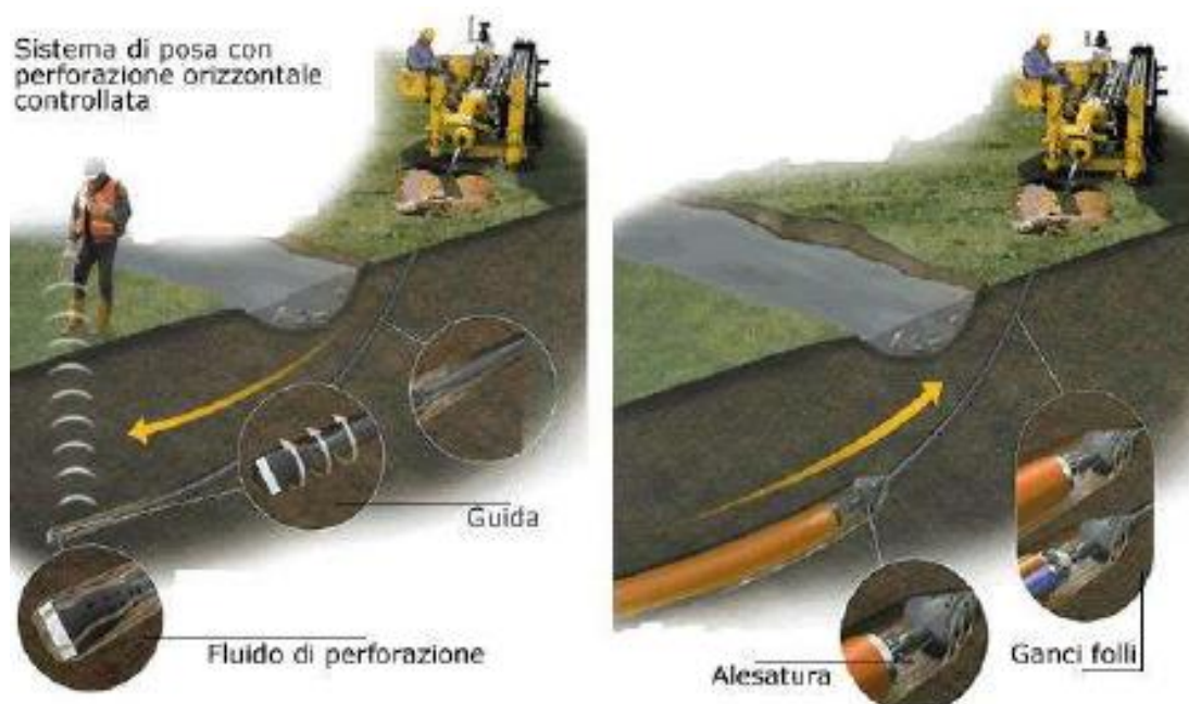
Posa in opera tubazione con trivellazione teleguidata
