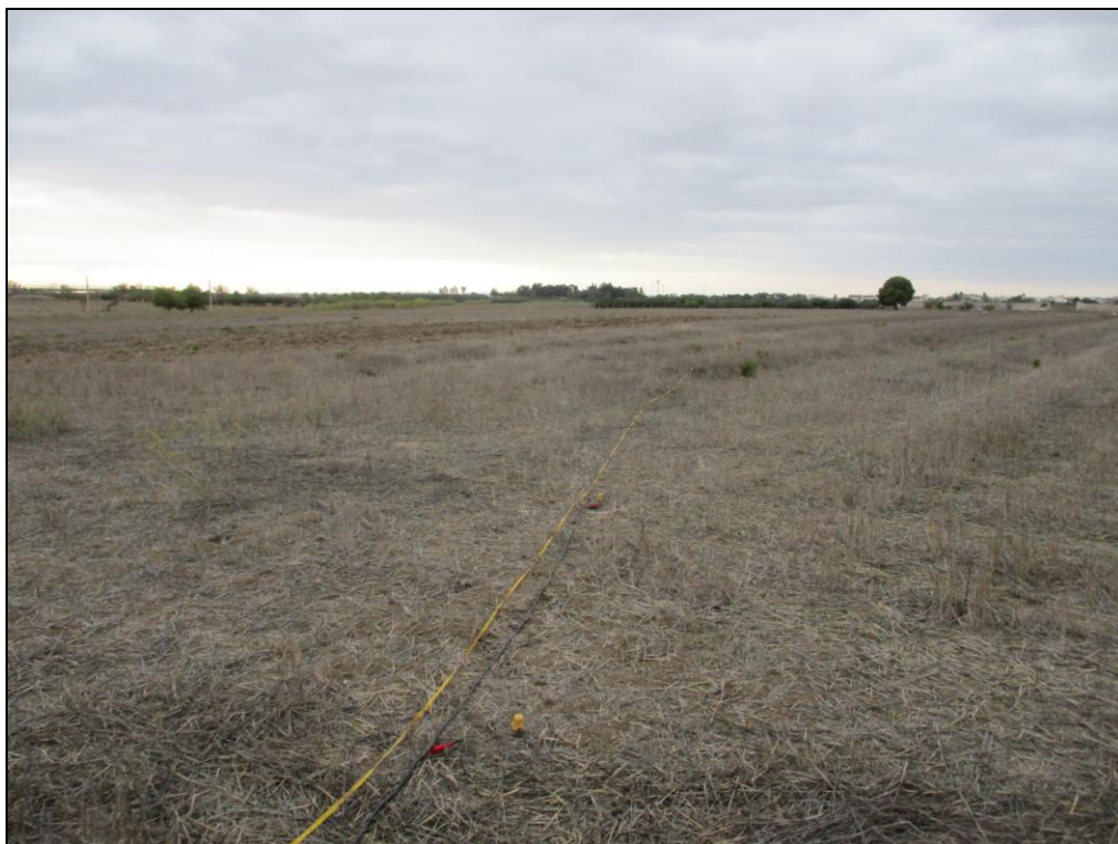
Esecuzione profilo sismico a rifrazione 2-2'
