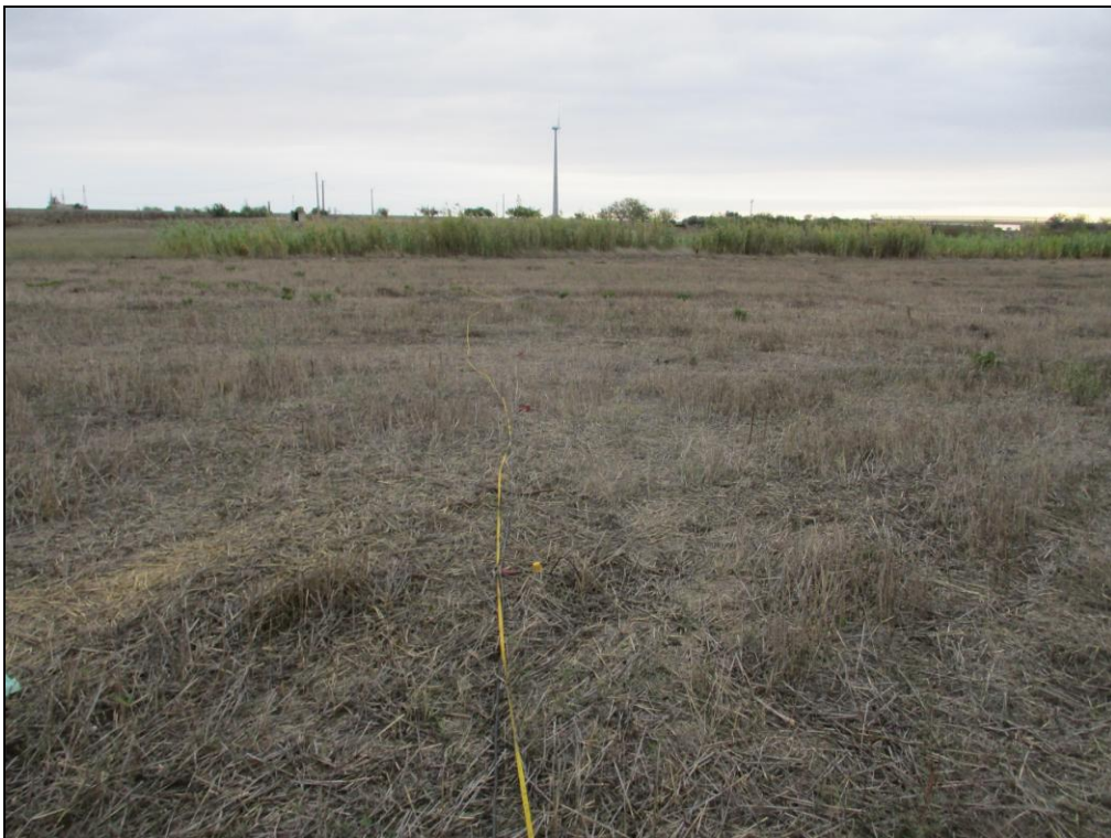
Esecuzione profilo sismico a rifrazione 3-3'
