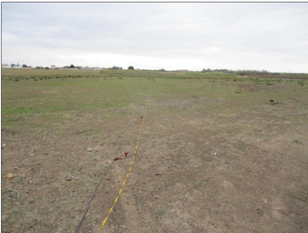
Esecuzione profilo sismico a rifrazione 1-1'
