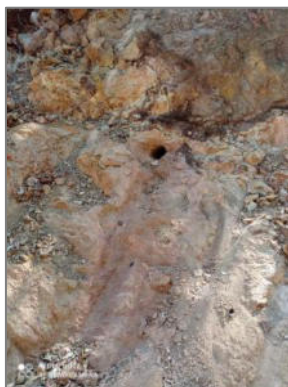
Figura 59 – Foro di sondaggio per campione roccia PA2
