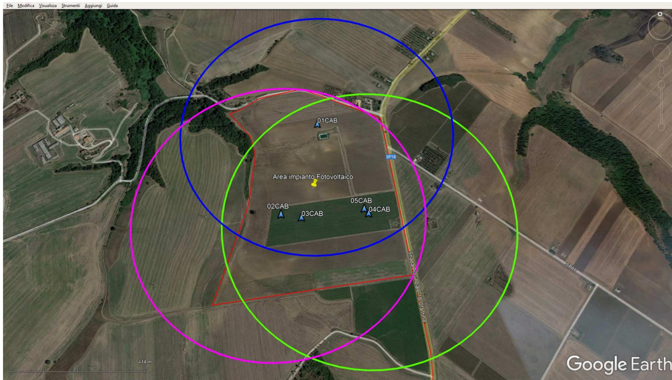
Tav.3 Ortofoto Area interessata con buffer di 500 metri dai singoli moduli MV POWER STATION SMA Solar Technology
