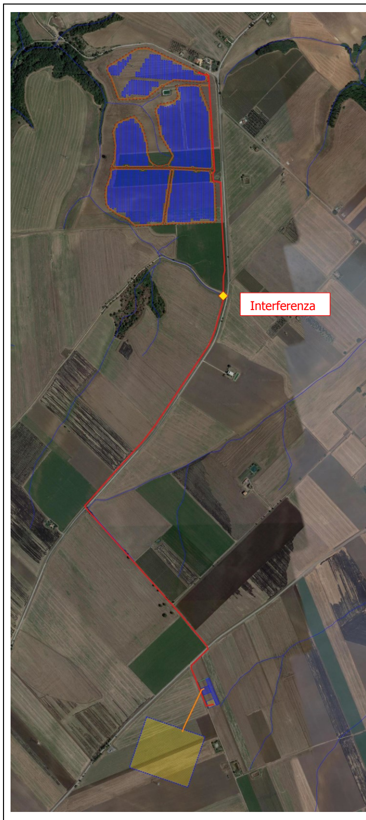
Figura 8. Interferenza tra cavidotto e reticolo idrografico.
