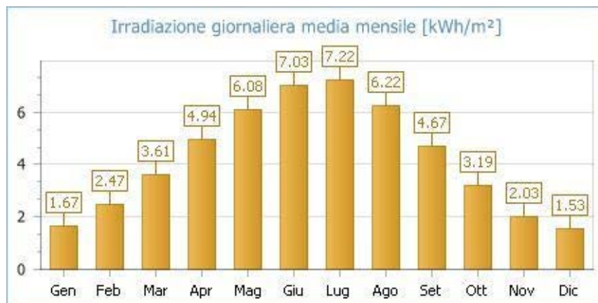
Figura 5.8. – Irradiazione giornaliera media mensile sul piano orizzontale [kwh/m²]- fonte dati: uni 10349 - località di riferimento: Potenza (PZ)/Matera (MT).
