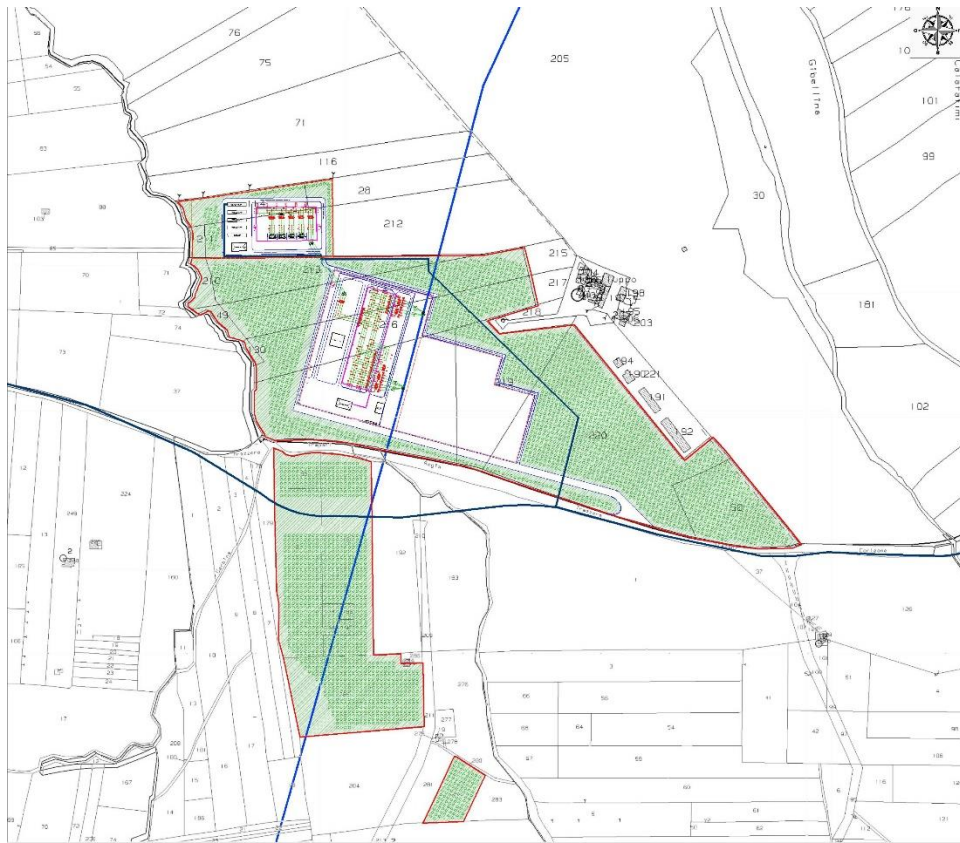
Figura 10 E – Layout della stazione rete-utente ricadente nel territorio di Gibellina (TP) - Contrada Casuzze su base catastale
