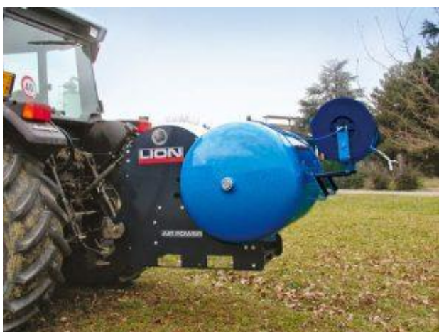
Fig.17: Compressore con attacco pto e cimatrice.
