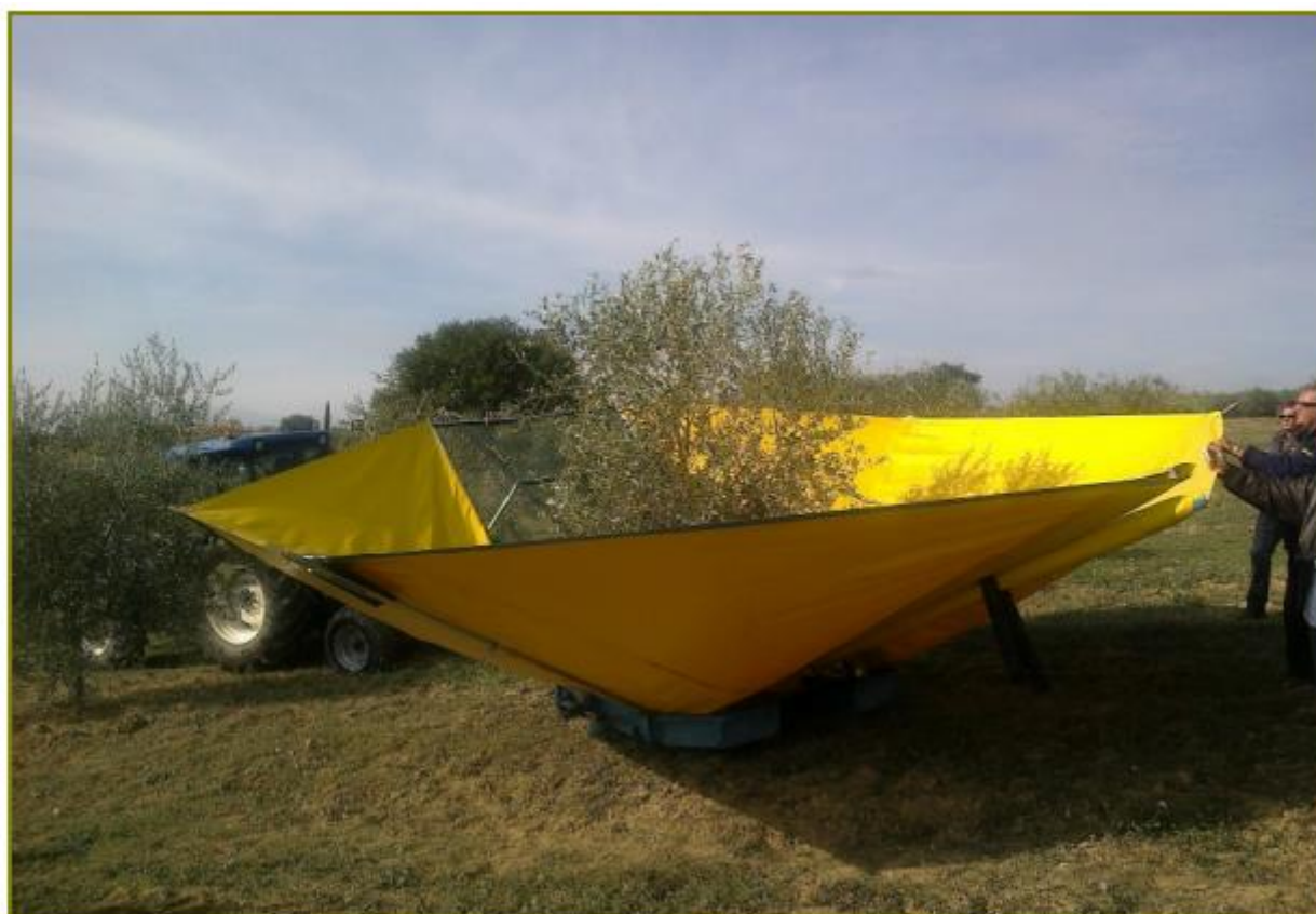
Fig.22: Raccolta meccanizzata con braccio vibratore e telaio intercettatore ad ombrello rovesciato.
