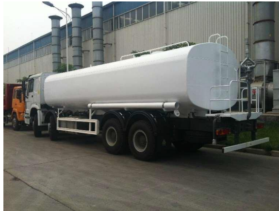
Camion che trasporta acqua con una capacità di 20 m 3
