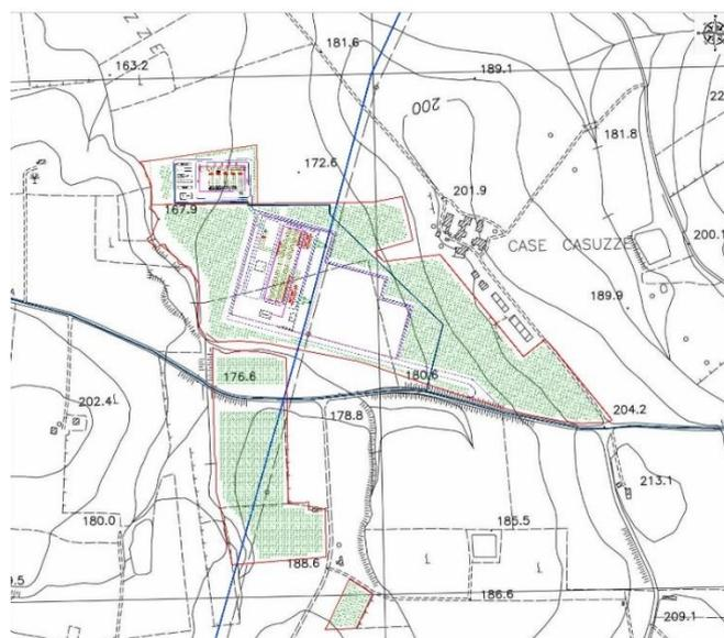
Figura 4 B – Layout della stazione ricadente sul territorio di Gibellina (TP - Contrada Casuzze) con cavidotto (TAV. IT-LAY)
