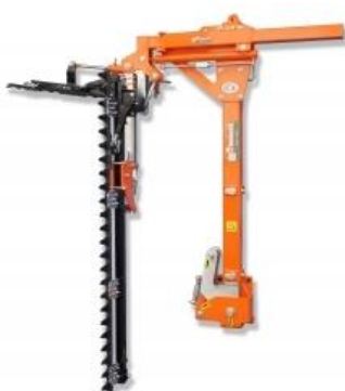
Fig.50 - Compressore con attacco pto e cimatrice.
