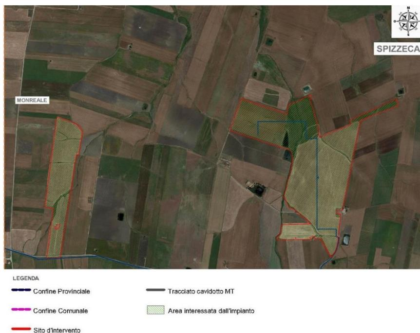
Figura3 D - Ortofoto dell'area di impianto ricadente in **Contrada Spizzeca (Morneale-PA)** e cavidotto di connessione
