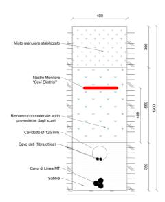
Il collegamento è realizzato mediante cavi ARE4H1R 18/30 kV 3X1X300 mmq, disposti prevalentemente a "trifoglio".
