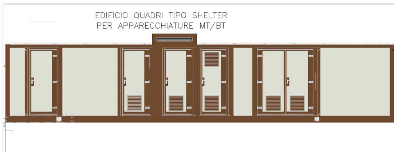
Fig. 7. Prospetto principale dei locali tecnici della SSE.
