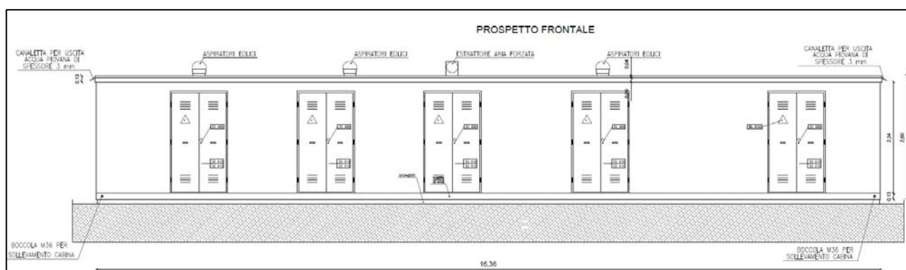
**Figura 30: Prospetto cabina di raccolta MT**
