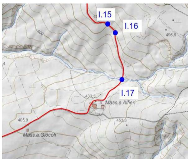
**Figura 85: Interferenze del cavidotto con reticolo idrografico superficiale**
