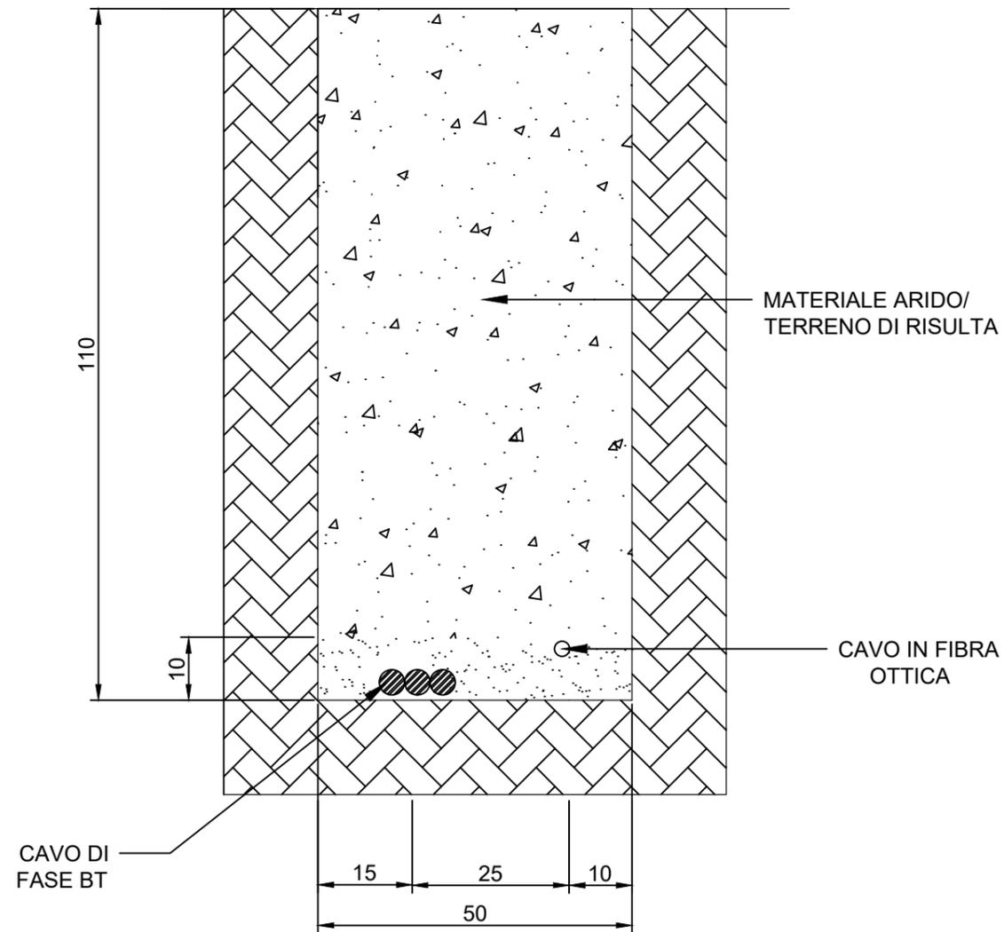
Sezione tipica di posa della linea BT in parallelo su strada sterrata.
