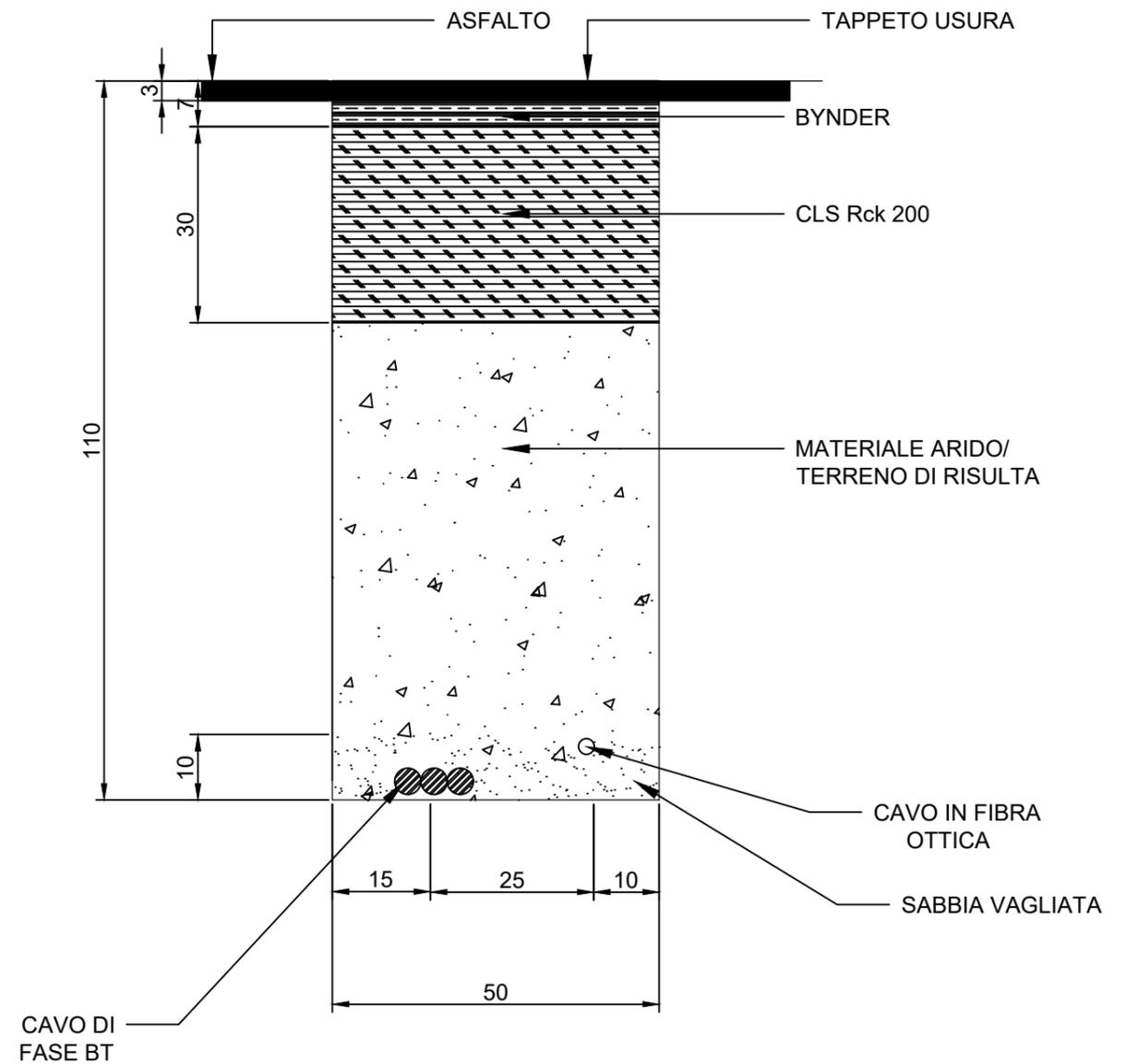
Sezione tipica di posa della linea BT in parallelo su sede stradale.
