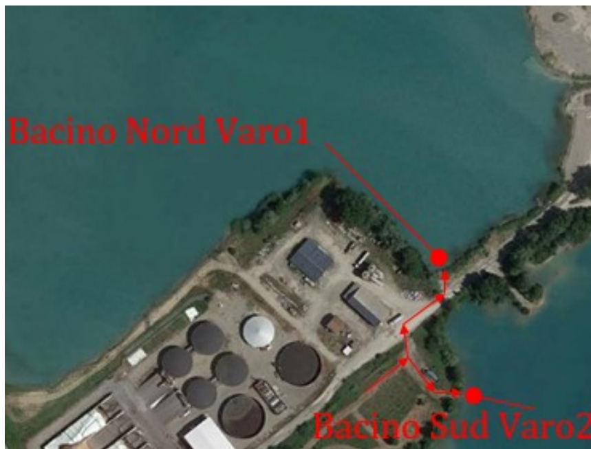
Figura 22. Aree per il varo in acqua dei moduli fotovoltaici
