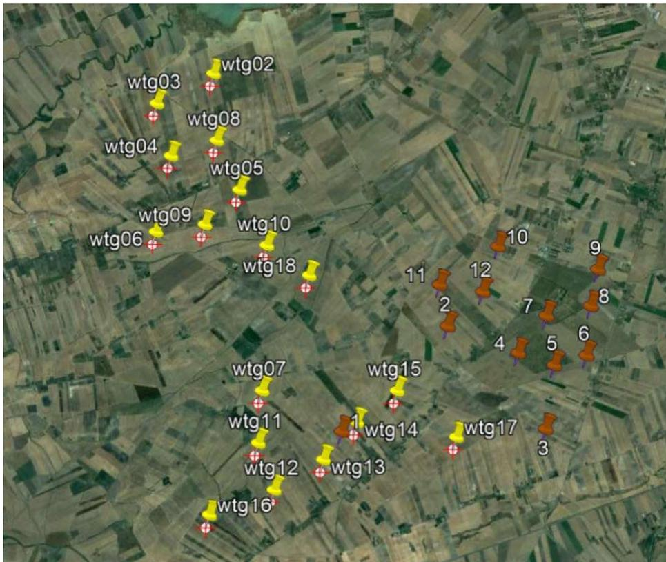
**[Figura 1]:** Inquadramento dei due impianti su ortofoto. In giallo sono rappresentate le WTG afferenti all'Impianto Eolico Statkraft; in marrone sono rappresentate le WTG afferenti all'Impianto Eolico Renexia.
