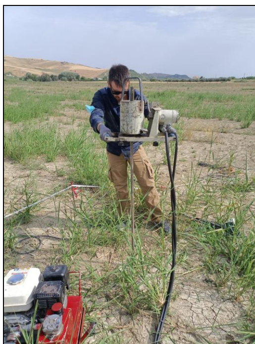
Fig. 1.5.1 – Esecuzione indagine penetrometrica dinamica media - D.P.M. 1
