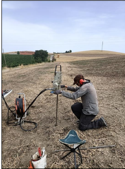
Fig. 1.5.15 – Esecuzione indagine penetrometrica dinamica media - D.P.M. 8
