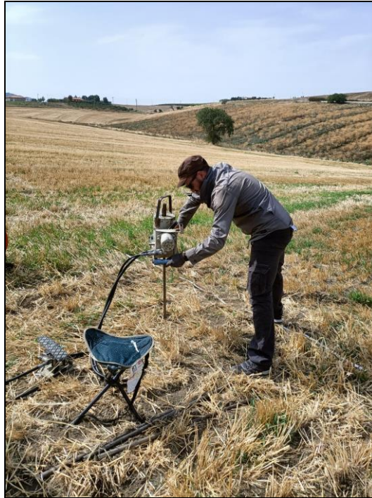
Fig. 1.5.19 – Esecuzione indagine penetrometrica dinamica media - D.P.M. 10
