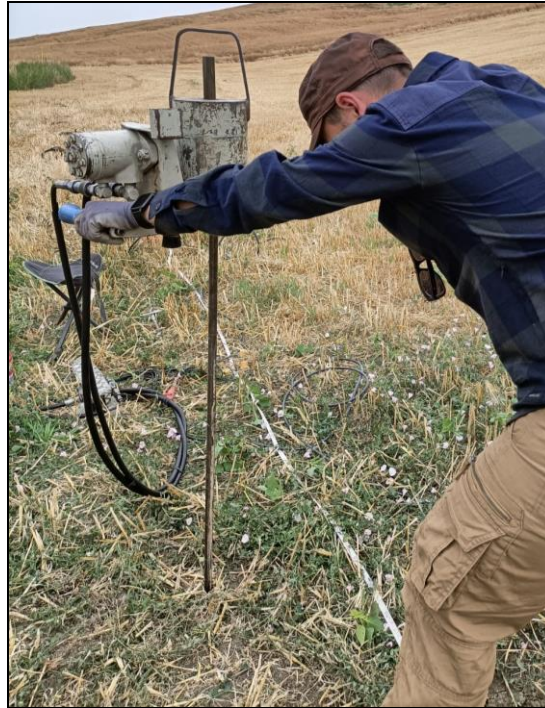
Fig. 1.5.21 – Esecuzione indagine penetrometrica dinamica media - D.P.M. 11
