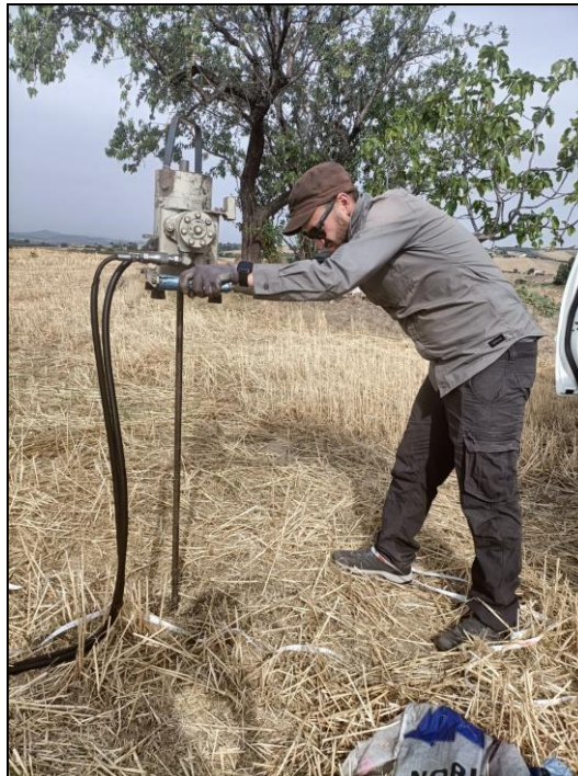
Fig. 1.5.17 – Esecuzione indagine penetrometrica dinamica media - D.P.M. 9
