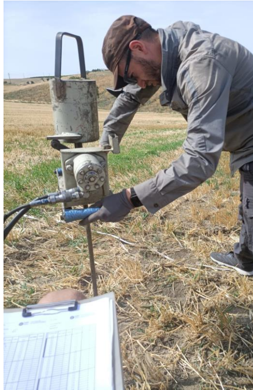
Fig. 1.5.23 – Esecuzione indagine penetrometrica dinamica media - D.P.M. 12
