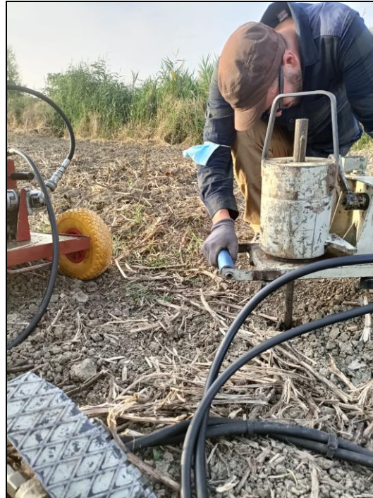
Fig. 1.5.5 – Esecuzione indagine penetrometrica dinamica media - D.P.M. 3
