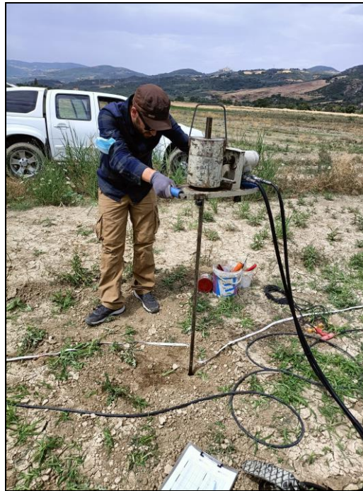
Fig. 1.5.3 – Esecuzione indagine penetrometrica dinamica media - D.P.M. 2
