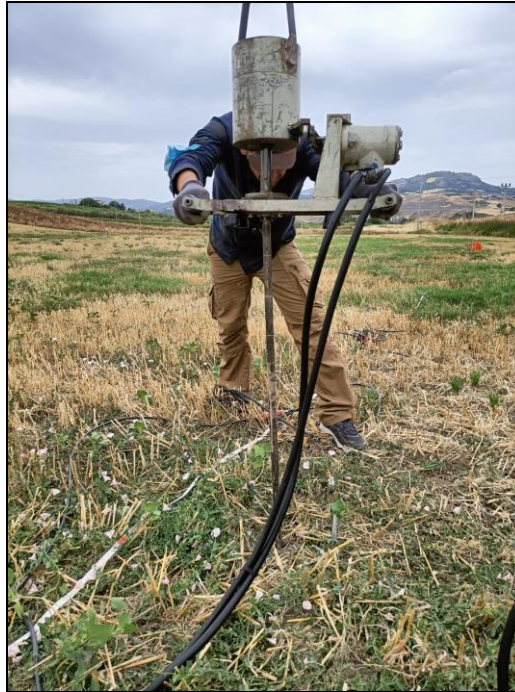
Fig. 1.5.7 – Esecuzione indagine penetrometrica dinamica media - D.P.M. 4
