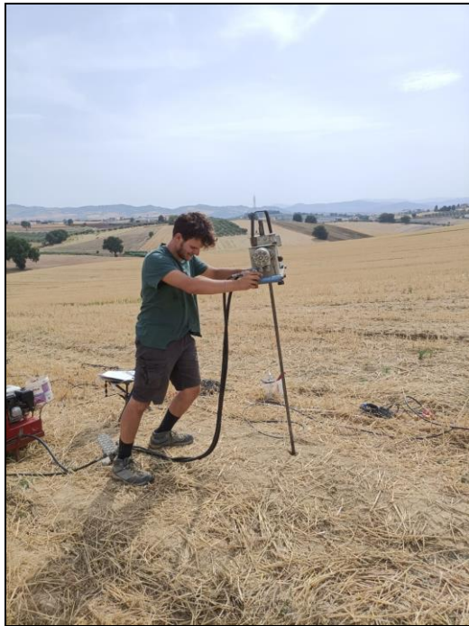
Fig. 1.5.11 – Esecuzione indagine penetrometrica dinamica media - D.P.M.6
