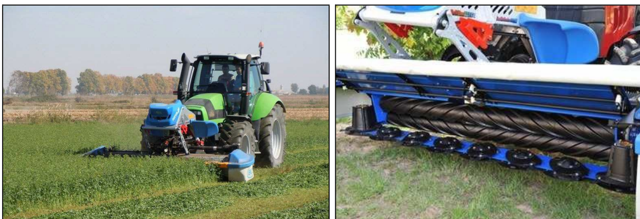
Figura 8 – Esempio di falciacondizionatrice frontale e particolare dei rulli in gomma
