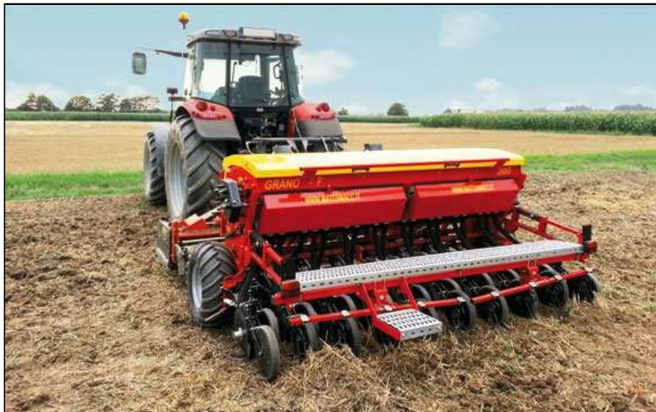
Figura 6 - Esempio di seminatrice di precisione per tutte le tipologie di sementi
