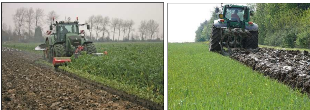
Figura 5 - Esempio di pratica del sovescio in pieno campo. Si noti, nell'immagine a sinistra, l'impiego di una trincia frontale montata sulla stessa trattore per alleggerire il carico sull'aratro portato
