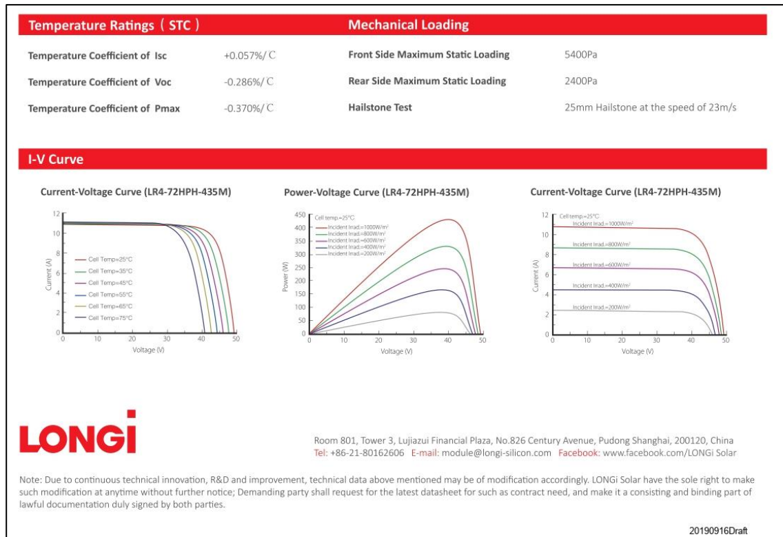
Figura 3.3: Caratteristiche Elettriche e Meccaniche del Modulo
