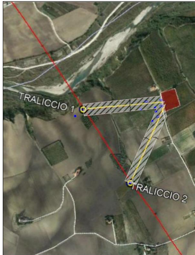
Figura 4.25: Collegamento AT alla RTN esistente
