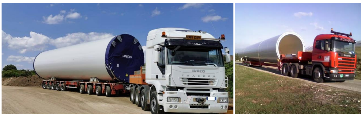
Figura 29 – Esempio di trasporto con convogli a pianale allungabile per conci di torre
