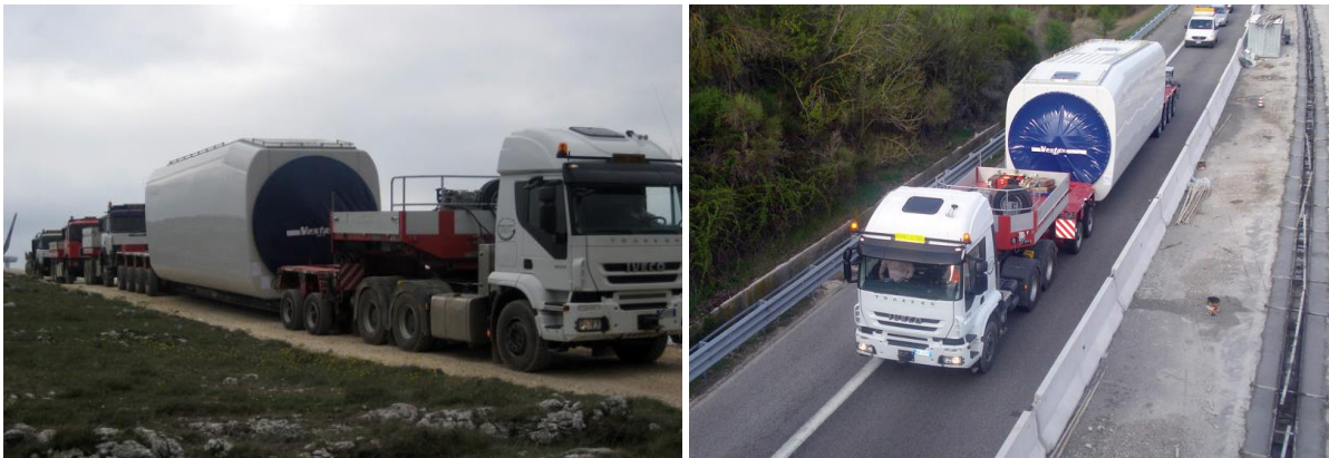
Figura 30 – Esempio di trasporto Nacelle
