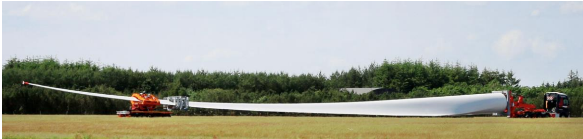
Figura 27 – Esempio di trasporto con “RBTS” (Rotor Blade Transport System)
