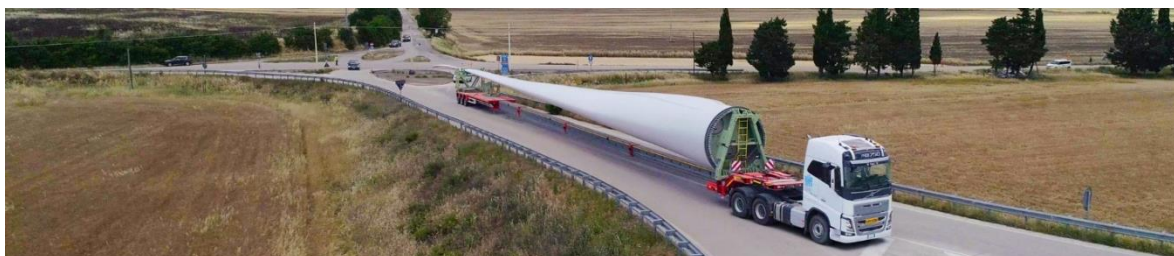
Figura 26 – Esempio di trasporto con SWC (Super Wing Carrier)
