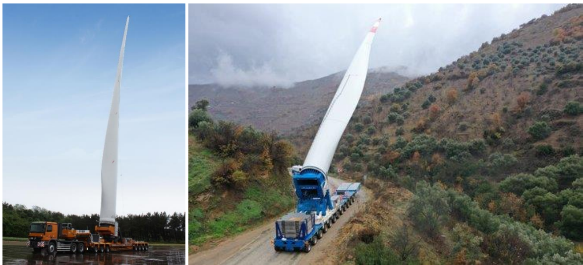
Figura 28 – Esempio di trasporto con Blade Lifter Trailer
