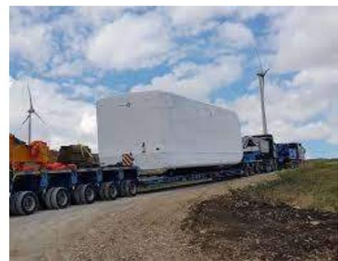
*Figura 82 - Soluzione tipo del trasporto dei conici di torre con adeguamento in curva sulla viabilità esistente e del trasporto della navicella*
