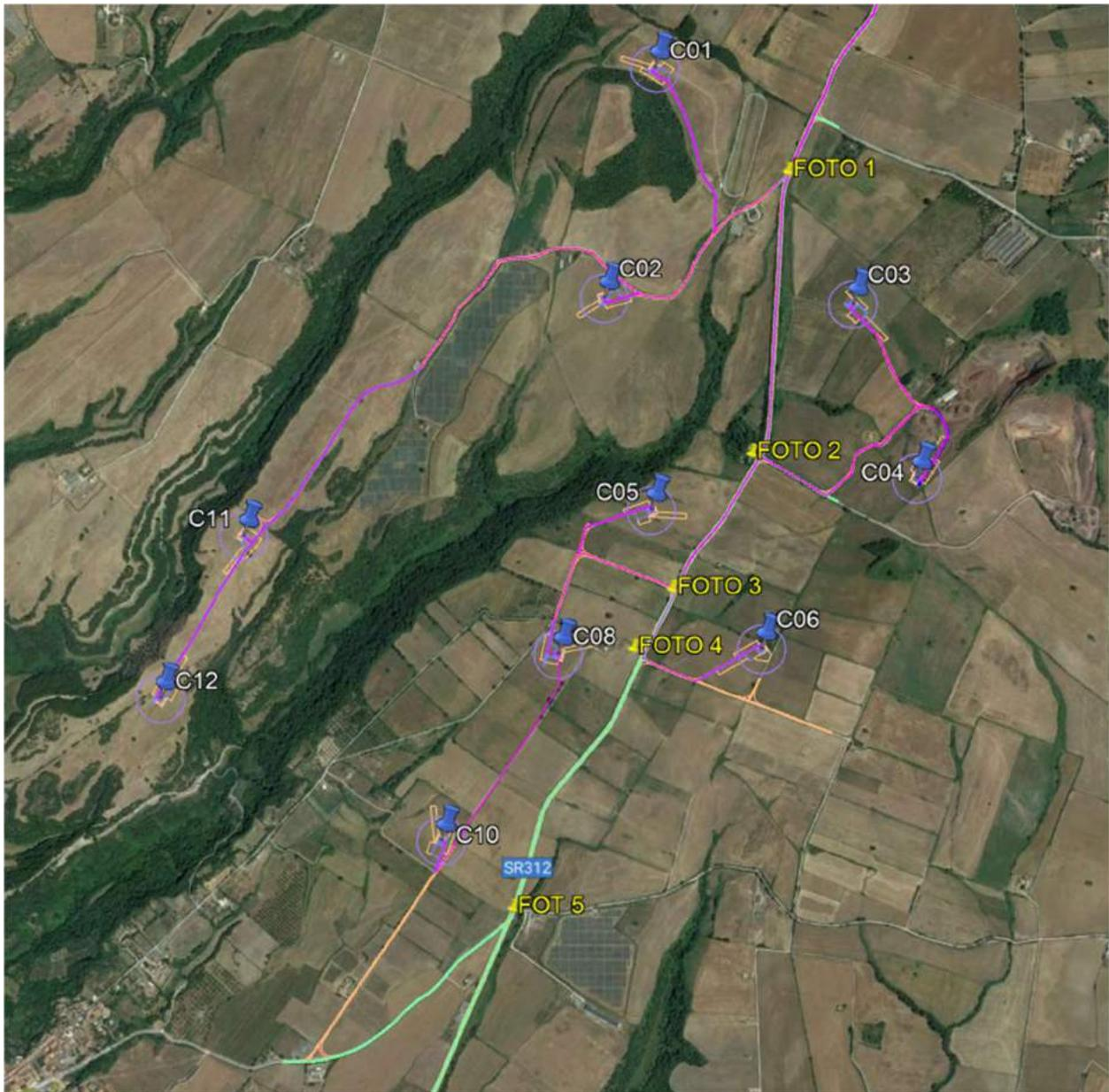
Figura 50 - Layout di impianto su ortofoto e individuazione dei punti di accesso per il raggiungimento degli aerogeneratori lungo la SR312
