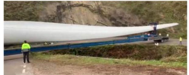
Figure 83 - Esempio di trasporto pale con tipologia SWC "Super Wing Carrier"
