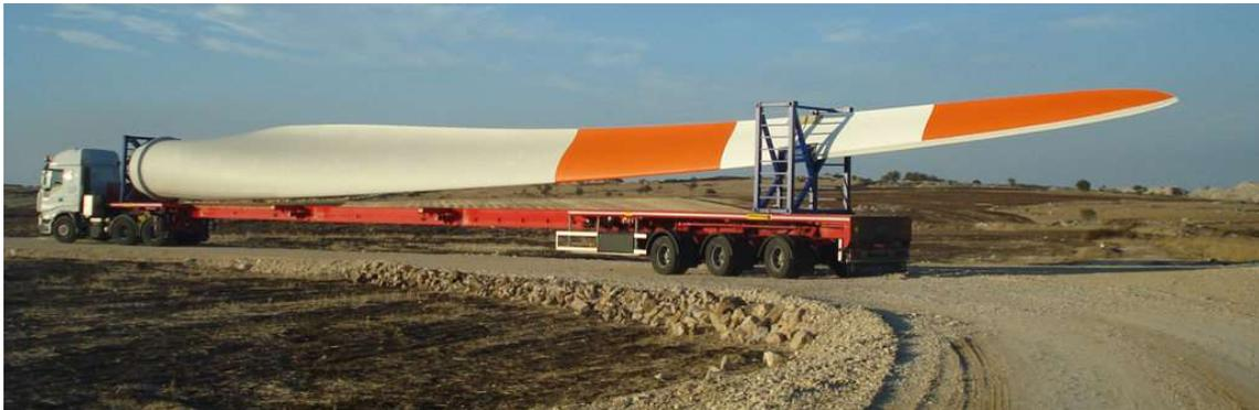
Figura 90 - Soluzione tipo del trasporto delle pale e adeguamento in curva tipo sulla viabilità esistente
