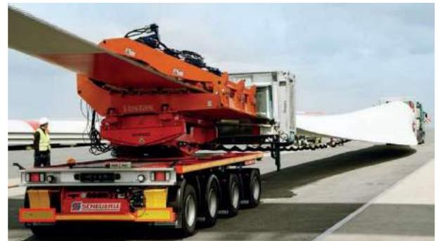
Figure 84 - Esempio di trasporto pale tipologia RBTS "Rotor Blade Transport System"
