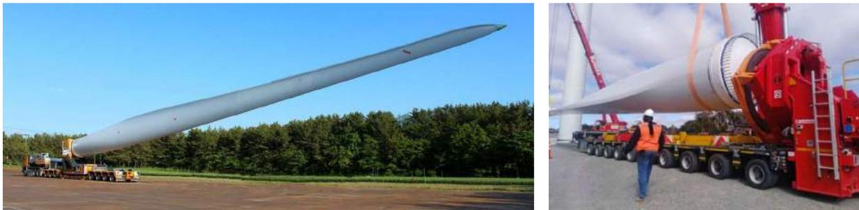
Figura 85 - Sistemi di trasporto pale: Blade Lifter Device
