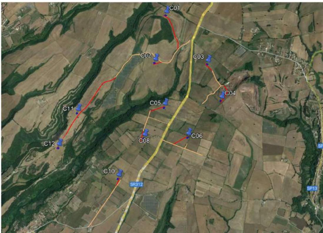
Figura 91 – Individuazione dei tratti di viabilità di nuova realizzazione e quelli ove sono previsti degli interventi di adeguamento
