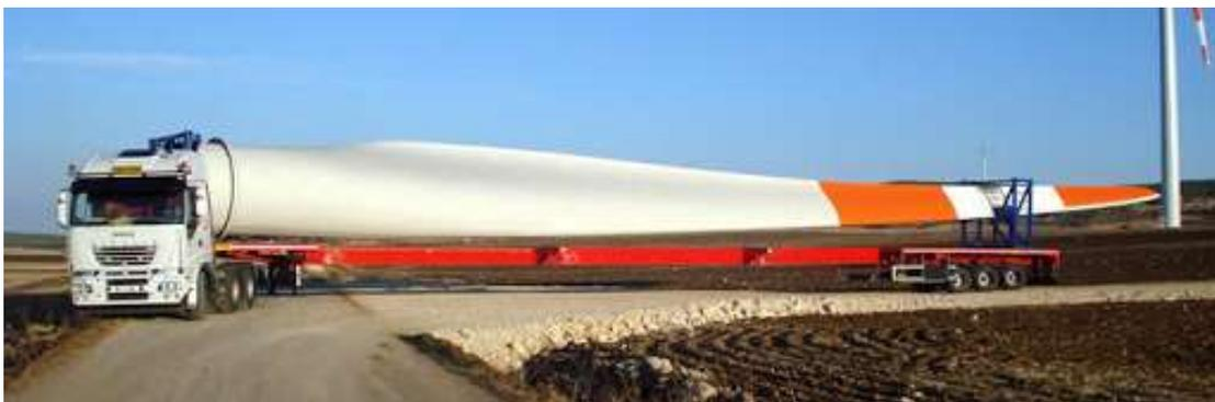
Figura 89 - Soluzione tipo del trasporto delle pale e pista di nuova realizzazione tipo per l'accesso alla turbina
