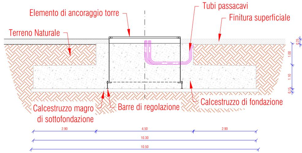
FONDAZIONE AEROGENERATORE A VALLE DELLA DISMISSIONE
