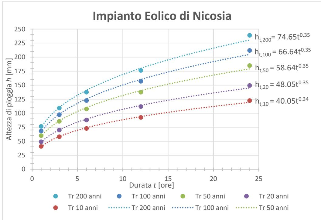
Figura 3-1: curve di possibilità pluviometrica
