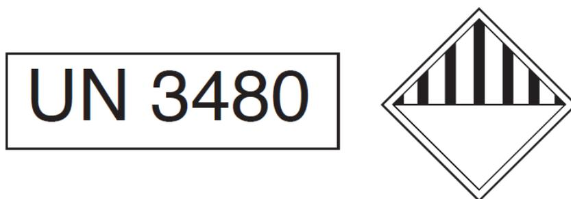
Figura 7. Etichetta per batterie litio-ioni
