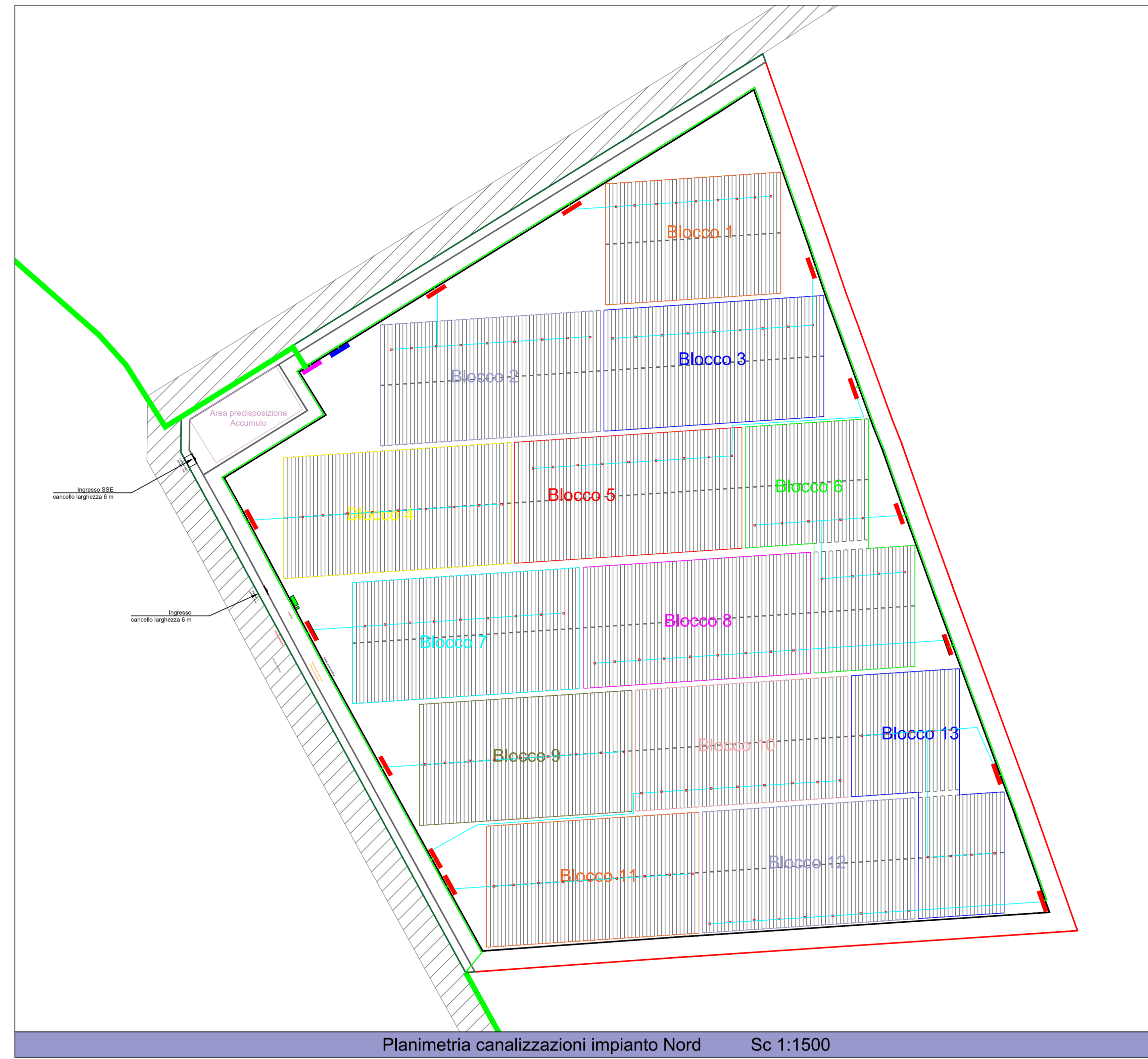
Planimetria canalizzazioni impianto Nord Sc 1:1500
