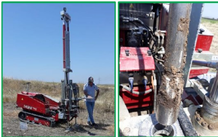
Figura 2: Penetrometro e punta utilizzati (DPSH 6).
