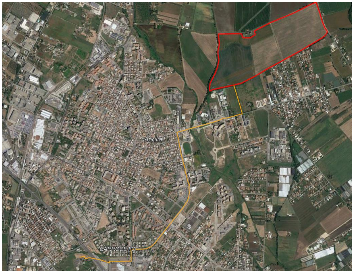
FIGURA 2 IMMAGINE SATELLITARE DELL'AREA OGGETTO DI INTERVENTO CON INDIVIDUAZIONE dell'area di installazione dell'impianto (in rosso) e di cavidotto interrato (in arancione)
