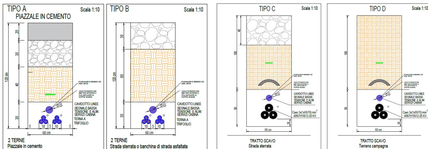
**FIGURA 78 - TIPOLOGIE SEZIONI DI SCAVO LINEE MT**
