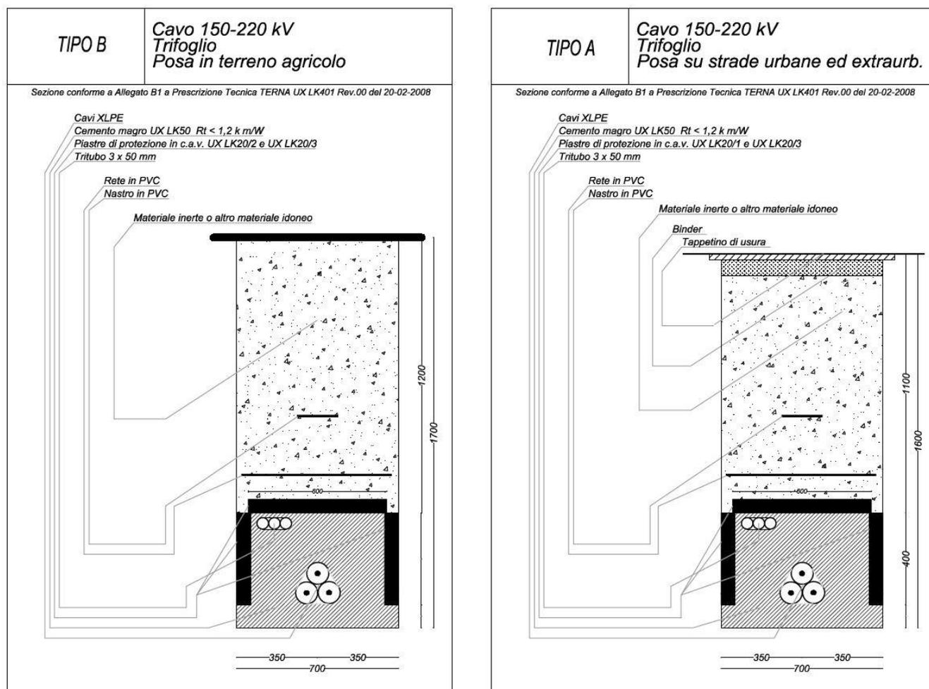
**Figura 556 - TIPOLOGIE SEZIONI DI SCAVO LINEE AT ESTERNE ALL'IMPIANTO**
