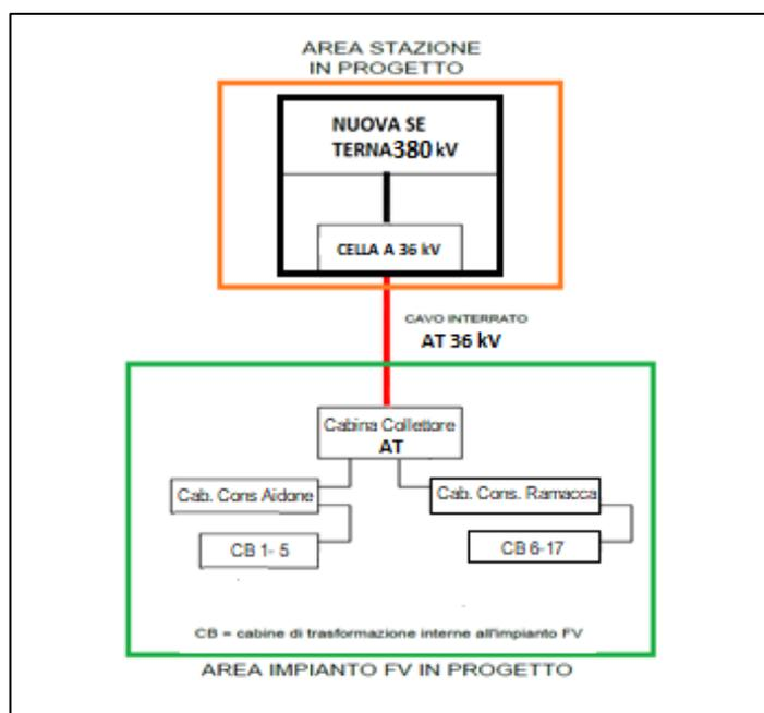
Figura 5: Schema a blocchi impianto
