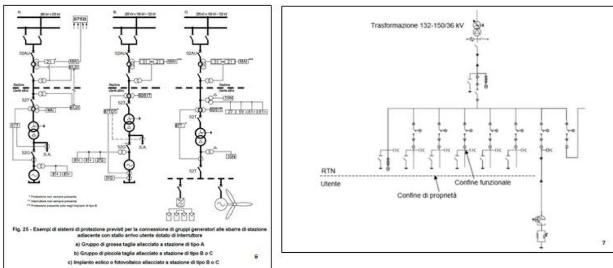
Figura 6 e 7: Schema di connessione generale con più utenti attivi (estratto da guida TERNA)
