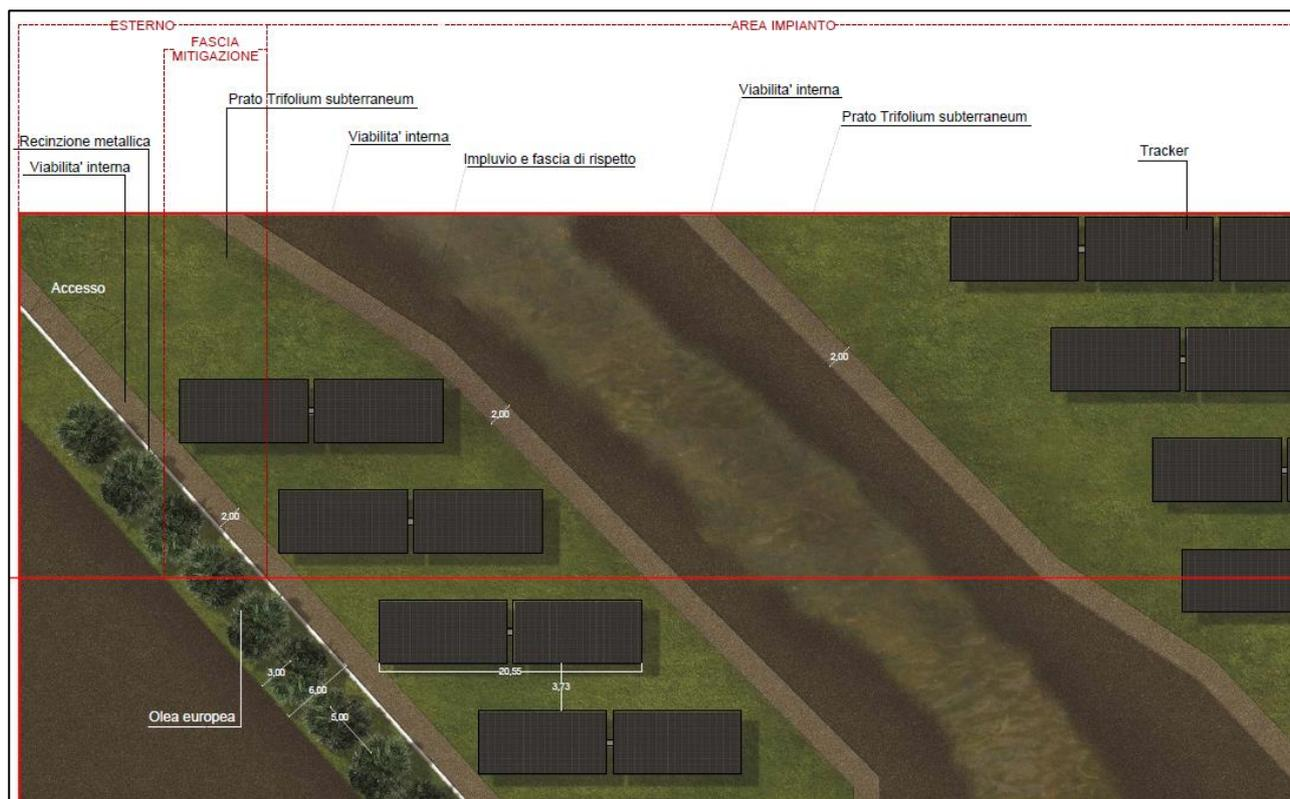
Figura 2: sezione della fascia di mitigazione e dell'area di impianto.
