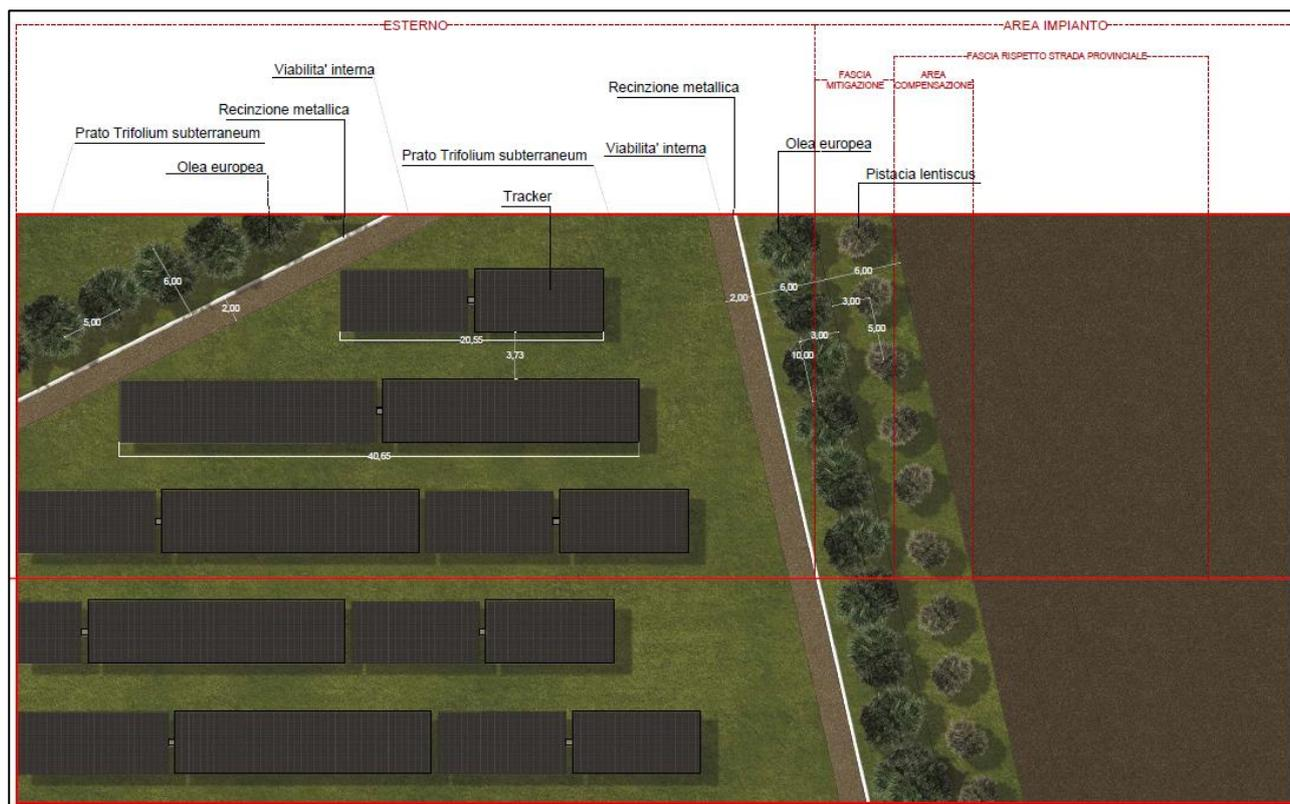
Figura 7: sezione dell'area di impianto, fascia di mitigazione e area di compensazione a *Pistacia lentiscus*.
