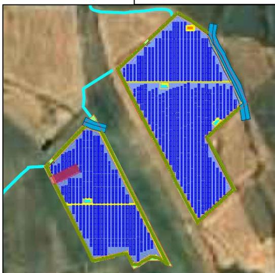
Figura 3: Planimetria sistemazione a verde – opere di mitigazione dell'Area 1.
