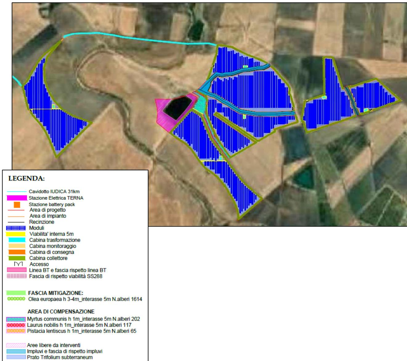
Figura 5: Planimetria sistemazione a verde – opere di mitigazione dell'Area 3.
