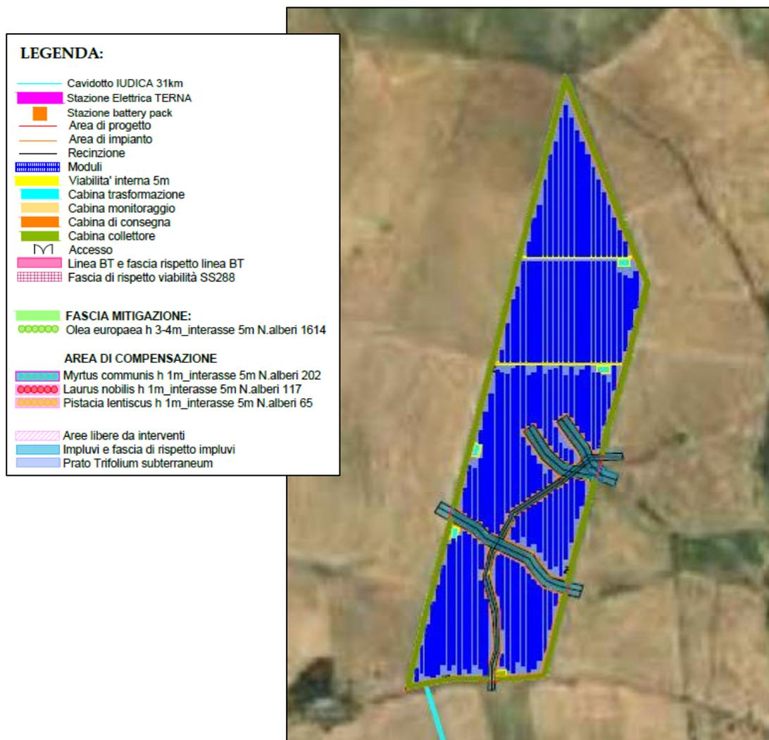
Figura 6: Planimetria sistemazione a verde – opere di mitigazione dell'Area 4.
