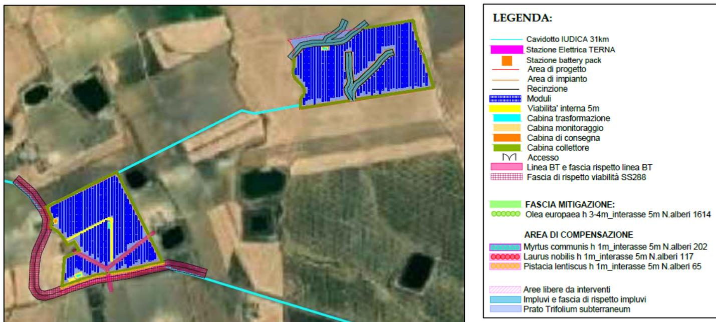
Figura 4: Planimetria sistemazione a verde – opere di mitigazione dell'Area 2.
