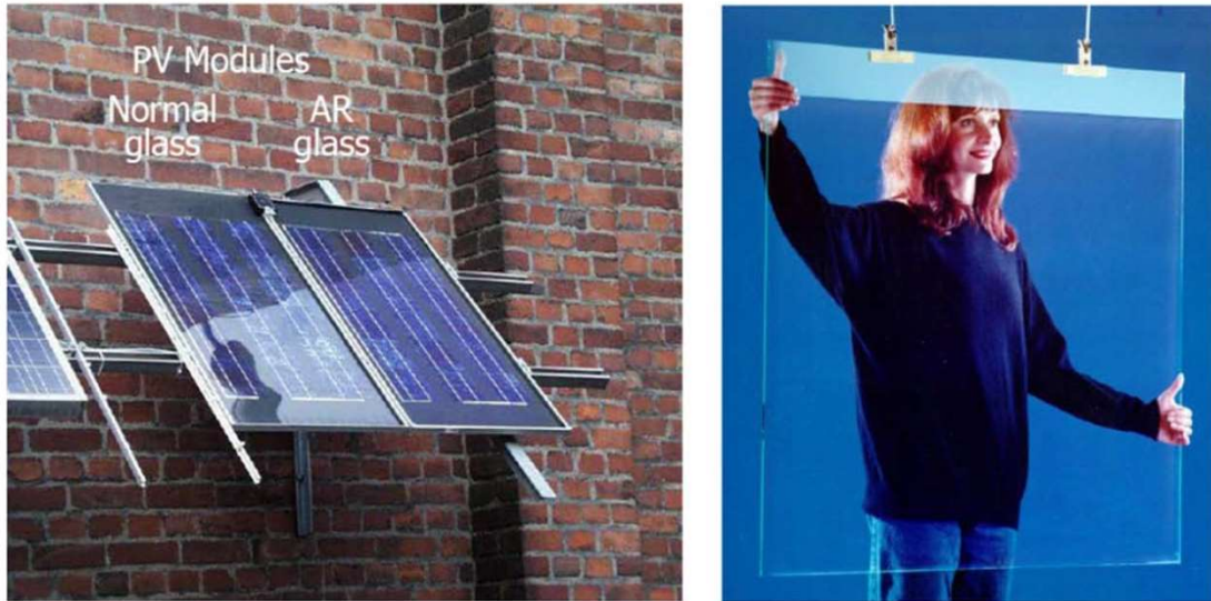
Figura 17. Le due immagini dimostrano in modo lampante come, al contrario di un vetro comune (normal glass), il vetro anti-riflesso (Anti-Reflecting glass) che riveste i moduli fotovoltaici (Photo Voltaic Modules) riduca drasticamente la riflessione dei raggi luminosi.
