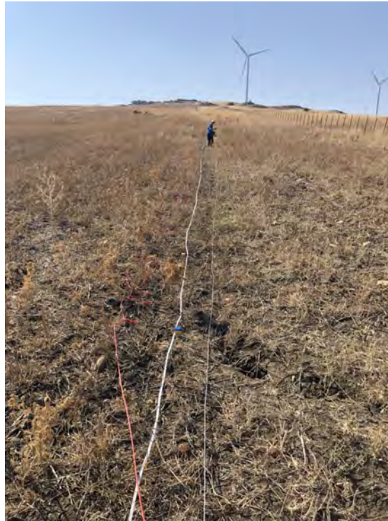
Foto Stendimento di sismica a rifrazione Rz1 e Mw1.
