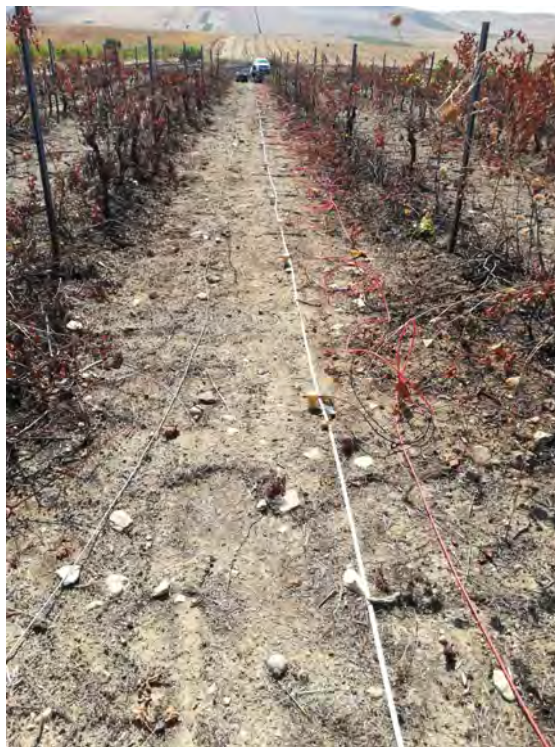
Foto Stendimento di sismica a rifrazione Rz4 e Mw4.
