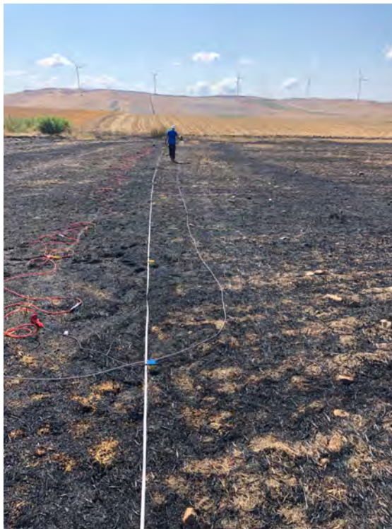
Foto Stendimento di sismica a rifrazione Rz3 e Mw3.
