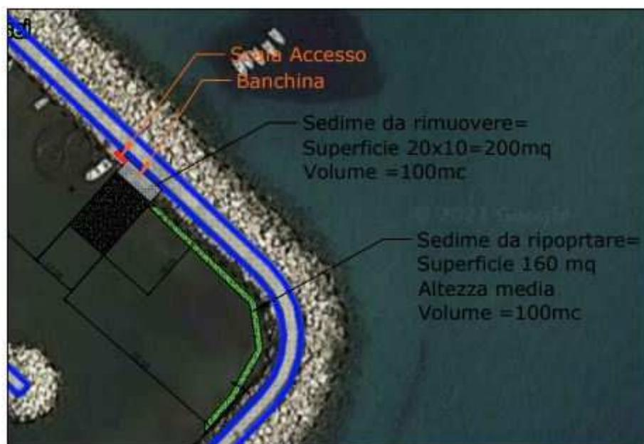
Figura 4 – Area di riposizionamento della sabbia prelevata
