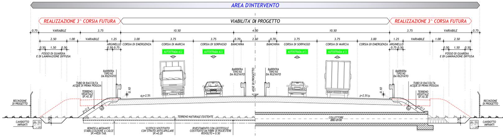
SEZIONE TIPO IN CURVA CON RILEVATO H<2.50m IN CORRISPONDENZA DEGLI ATTRAVERSAMENTI IDRAULICI
