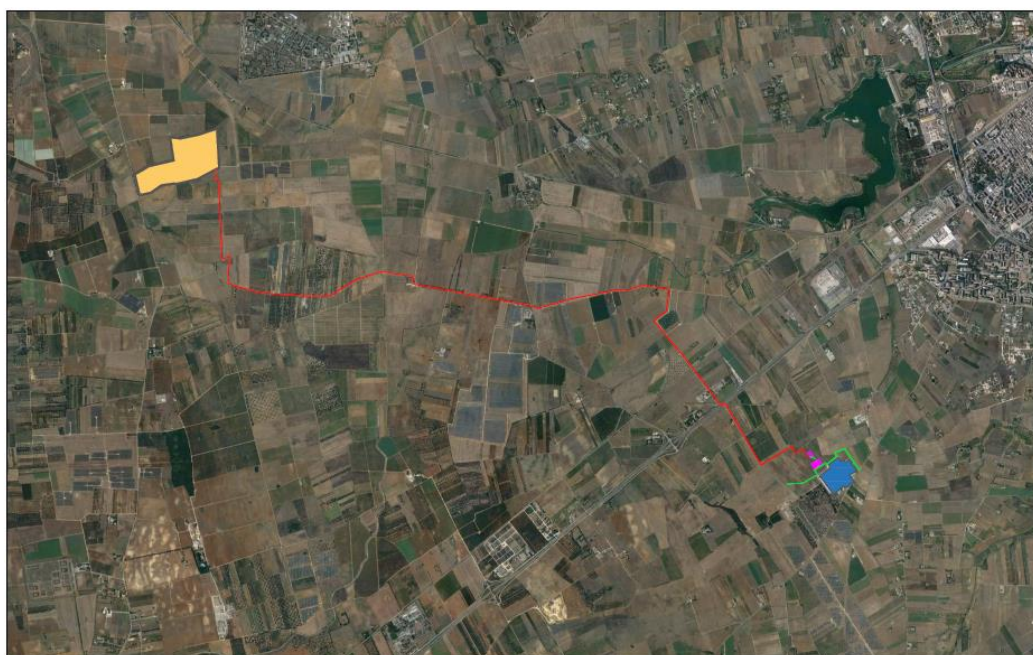
Figura 5: Inquadratura globale su Ortofoto dell'intero impianto (sito + tracciato cavidotto) fino al raggiungimento della stazione elettrica Terna
