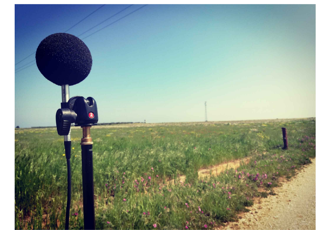
RILIEVO STRUMENTALE IN SITO VALUTAZIONE DI IMPATTO ACUSTICO
