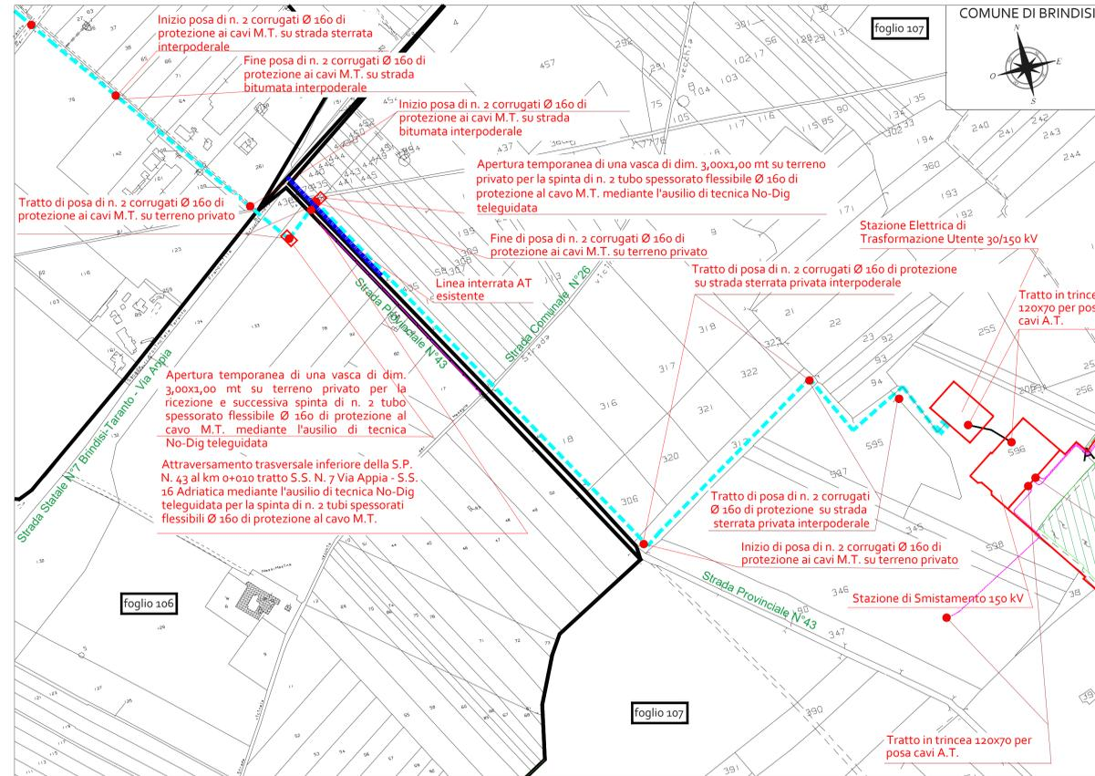
PIANTA RELATIVA ALL'ATTRAVERSAMENTO TRASVERSALE ED INFERIORE DELLA S.P. N. 43 AL KM 0+010 TRATTO S.S. N. 7 VIA APPIA - S.S. 16 ADRIATICA DI N. 2 TUBI SPESSORATI FLESSIBILE Ø 160 DI PROTEZIONE AL CAVO M.T. MEDIANTE TECNICA NO-DIG TELEGUIDATA
