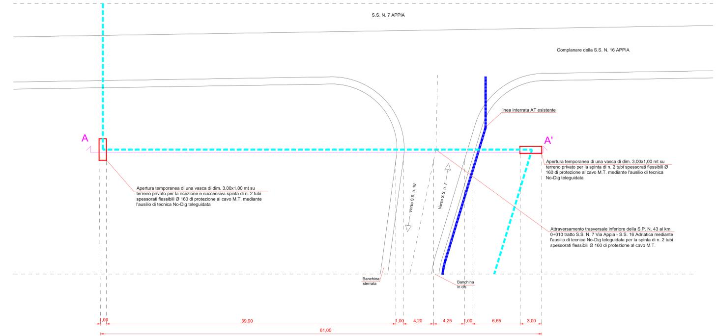
SEZIONE RELATIVA ALL'ATTRAVERSAMENTO TRASVERSALE ED INFERIORE DELLA S.P. N. 43 AL KM 0+010 TRATTO S.S. N. 7 VIA APPIA - S.S. 16 ADRIATICA DI N. 2 TUBI SPESSORATI FLESSIBILE Ø 160 DI PROTEZIONE AL CAVO M.T. MEDIANTE TECNICA NO-DIG TELEGUIDATA
