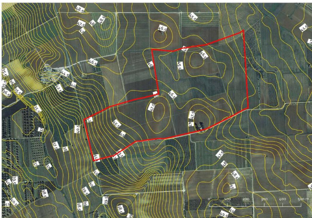
Figura 1: Individuazione dell'area di impianto con indicazione delle curve di livello ogni 0,5m. Tutte le quote sono riferite al livello medio mare.
