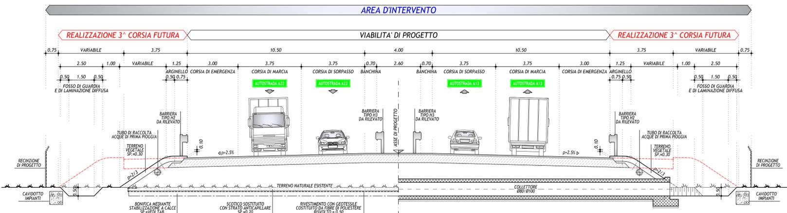
SEZIONE TIPO IN RETTIFILLO CON RILEVATO H<2.50m IN CORRISPONDENZA DEGLI ATTRAVERSAMENTI IDRAULICI
