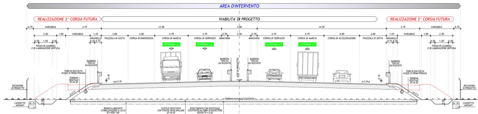
SEZIONE TIPO IN RETTIFILO CON CORSIE DI ACCELERAZIONE E DECELERAZIONE
