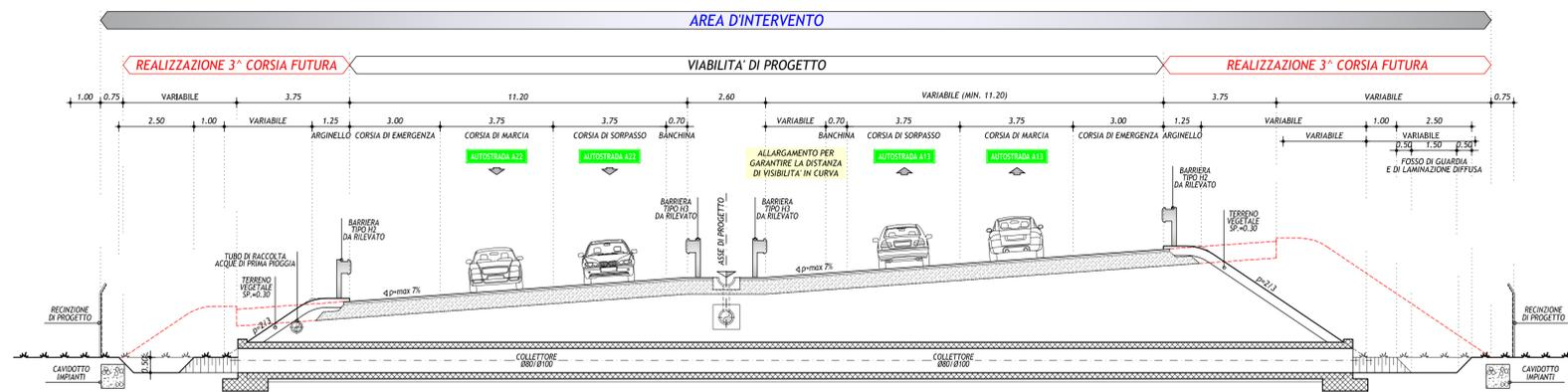
SEZIONE TIPO IN RETTIFILO CON PIAZZOLE DI SOSTA
