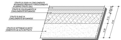
SEZIONE TIPO IN CURVA CON RILEVATO H<2.50m IN CORRISPONDENZA DEGLI ATTRAVERSAMENTI IDRAULICI
