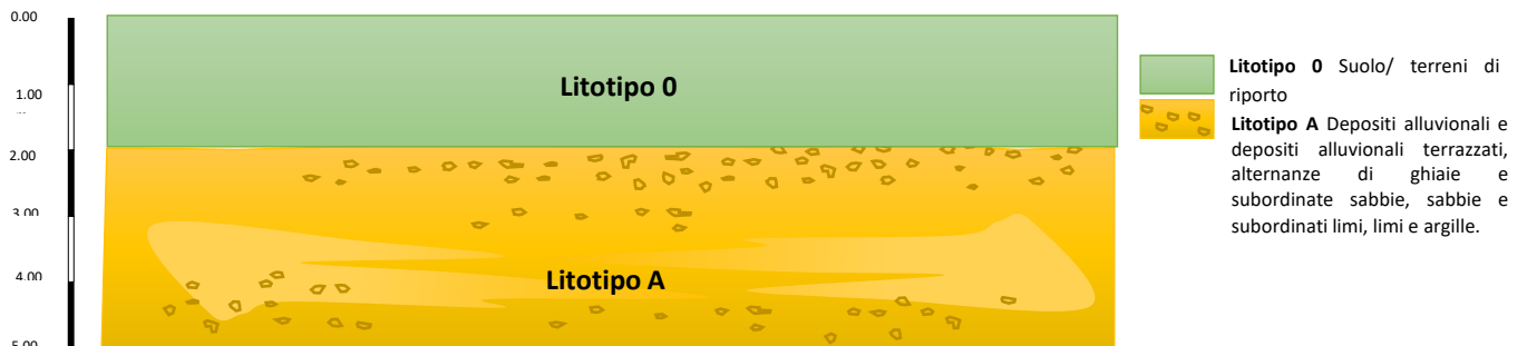
Figura 23 Modello geologico del sito (6.2.1 NTC 2018)
