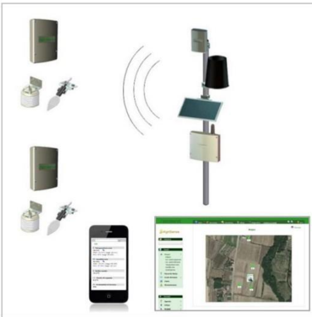
Figura n.7: Stazione principale e sensori meteo climatici.
