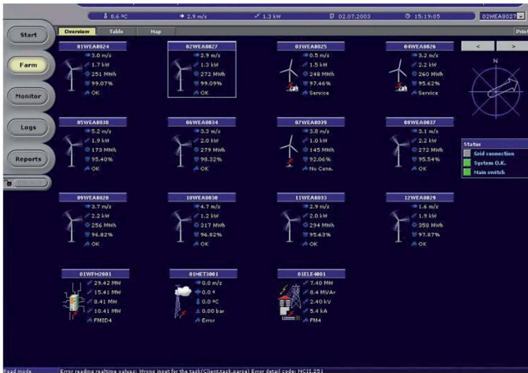
Figura 8: monitoraggio remoto di una Wind Farm
