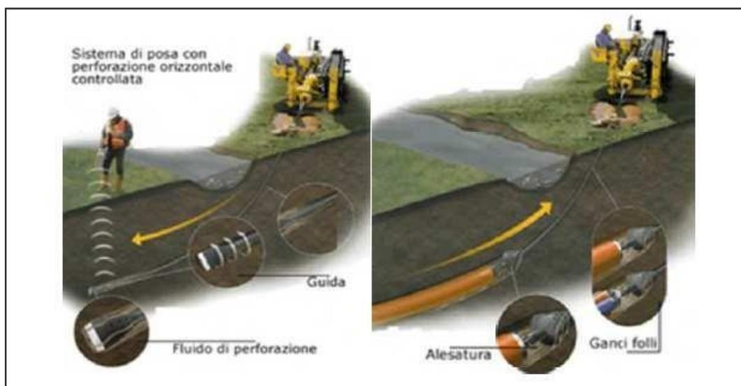
Fig. 16: Tecnica di Scavo TOC
