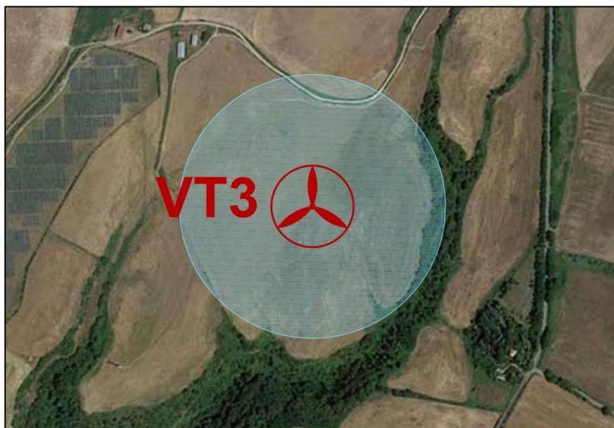
Figura 4 Massima area di caduta aerogeneratore VT3
