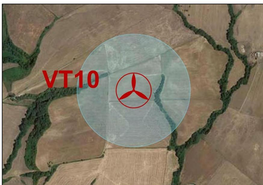
Figura 11 Massima area di caduta aerogeneratore VT10
