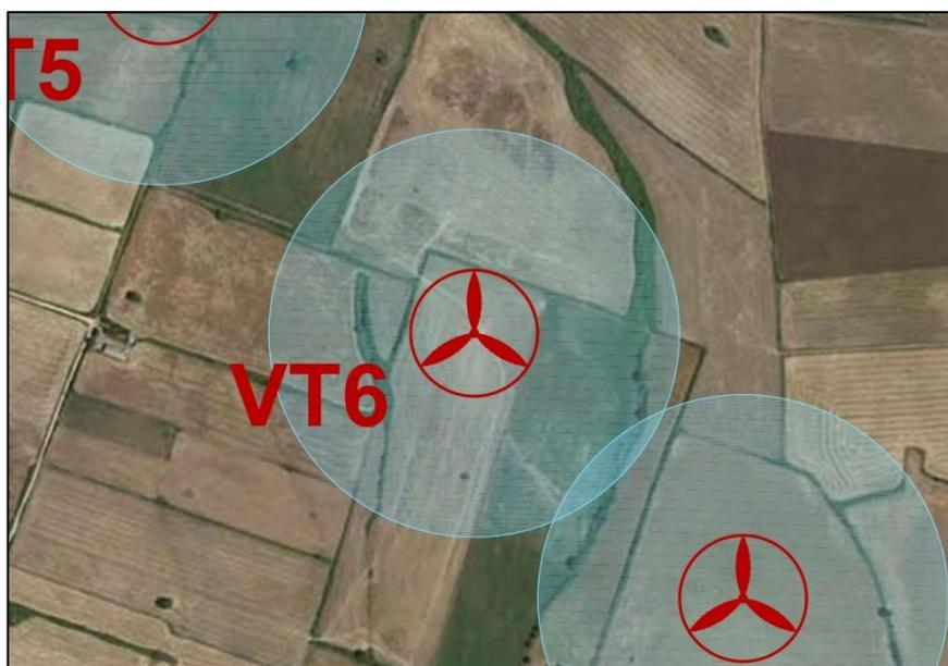
Figura 7 Massima area di caduta aerogeneratore VT6
