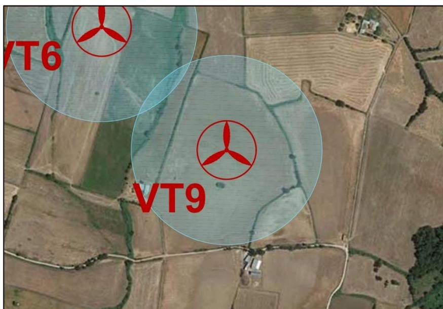
Figura 10 Massima area di caduta aerogeneratore VT9
