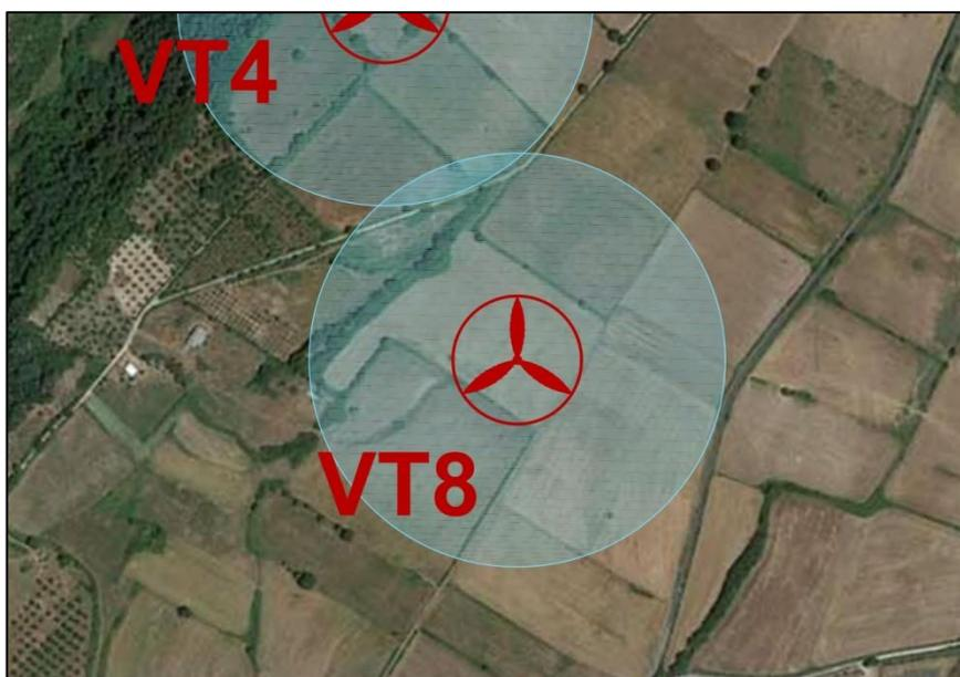
Figura 9 Massima area di caduta aerogeneratore VT8
