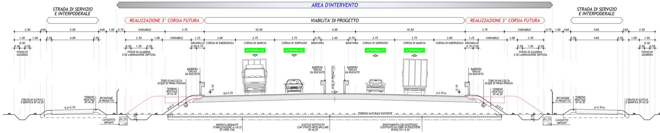
SEZIONE TIPO IN RETTIFILLO CON RILEVATO H<2.50m
