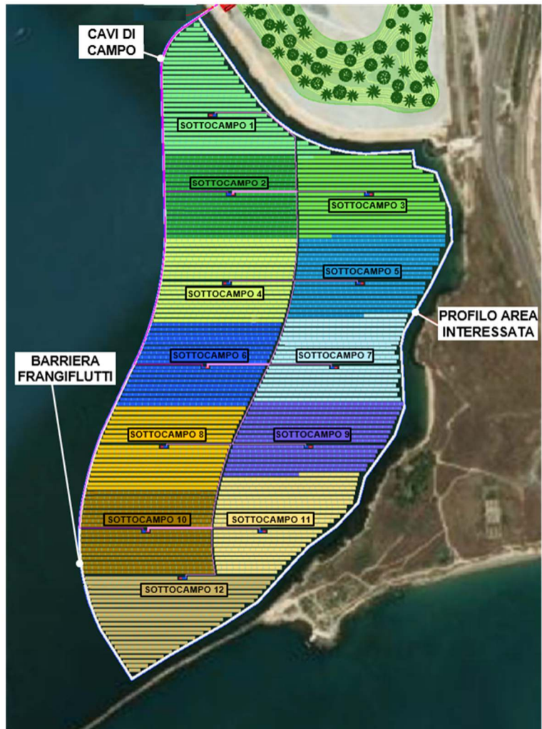
Figura 4.1 – Layout dell'impianto fotovoltaico.
